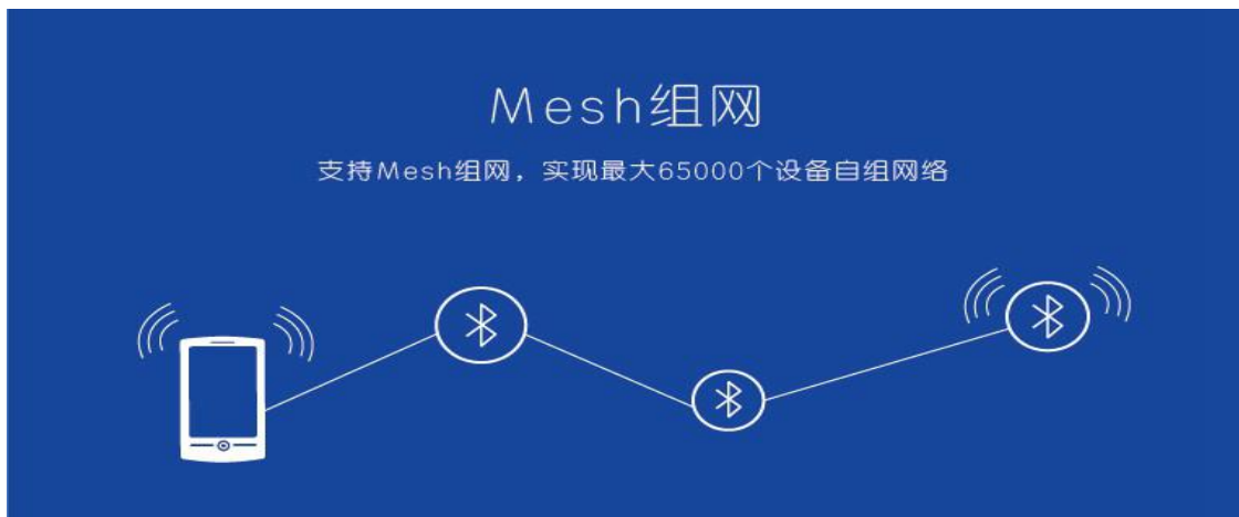
图 9. Mesh 组网示意图
