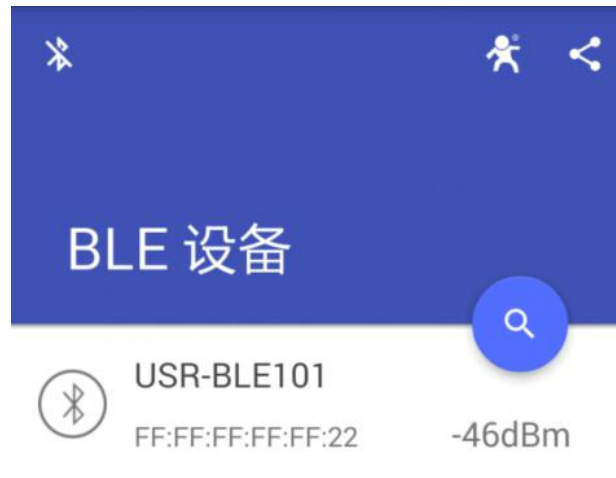
图 4. 手机搜索蓝牙模块示意图
