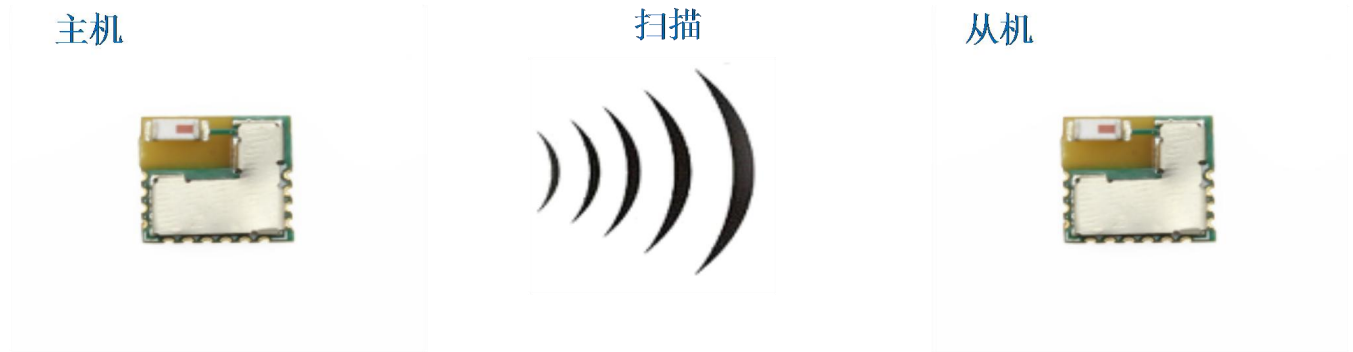
图 11. 主设备扫描示意图
