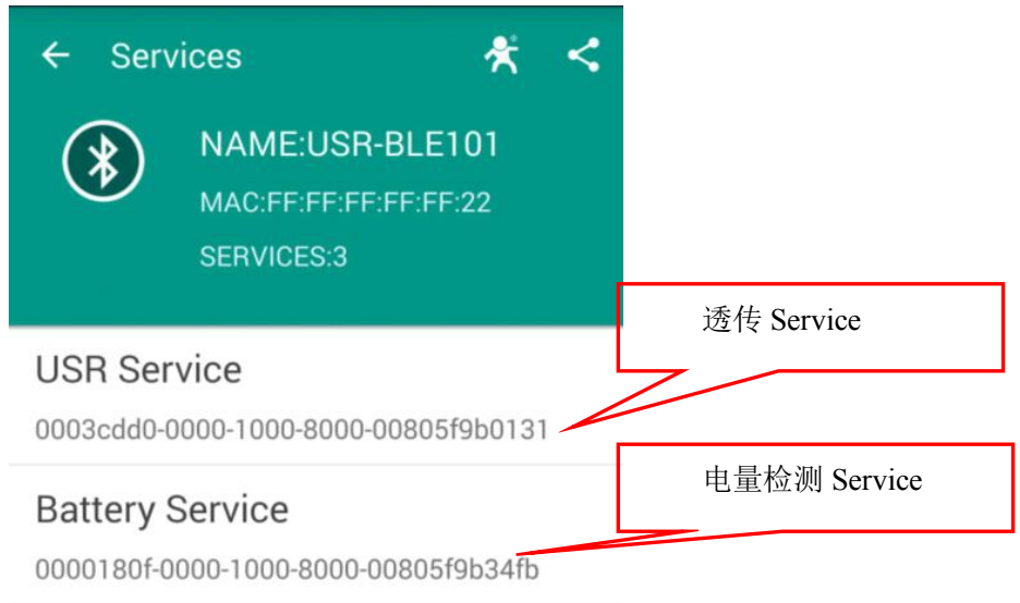
图 5. 模块 Service 示意图
