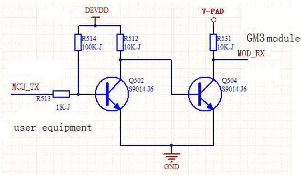
注: 如果客户 MCU 的 I/O 电源电压为 3.3V 时, 模块的 MOD\_RX 端可不用进行电平匹配。
