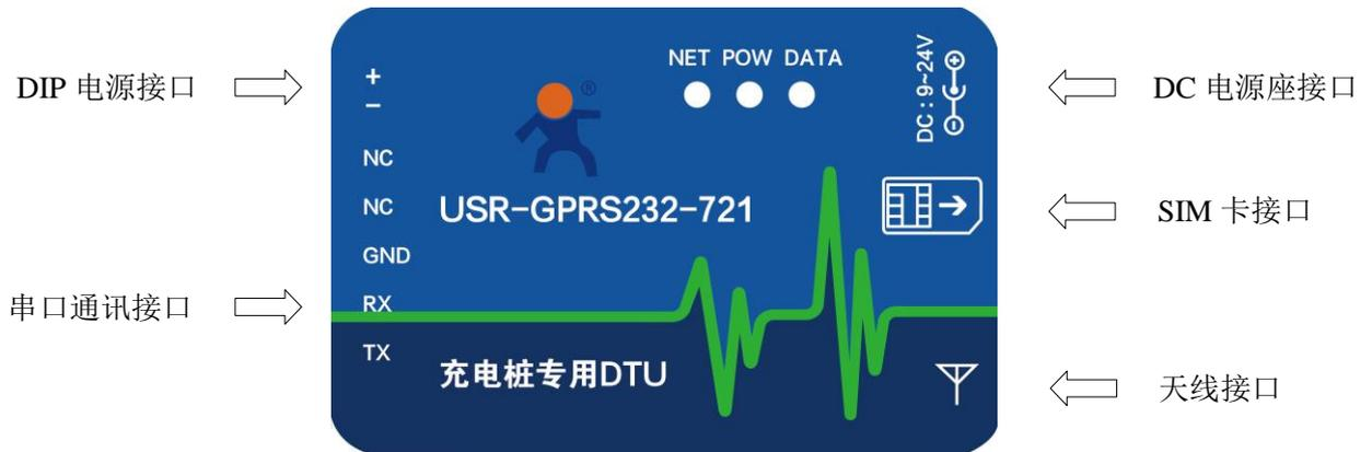
图 1 USR-GPRS232-721 接口图
