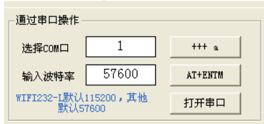
图 49 设置软件串口参数示意图
