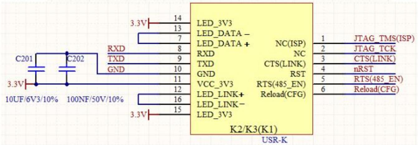
图 5 USR-K2 电源接口示意图
