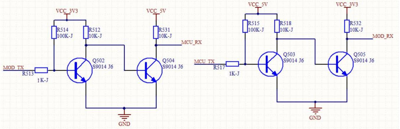
图 7 UART 电平转换参考设计
