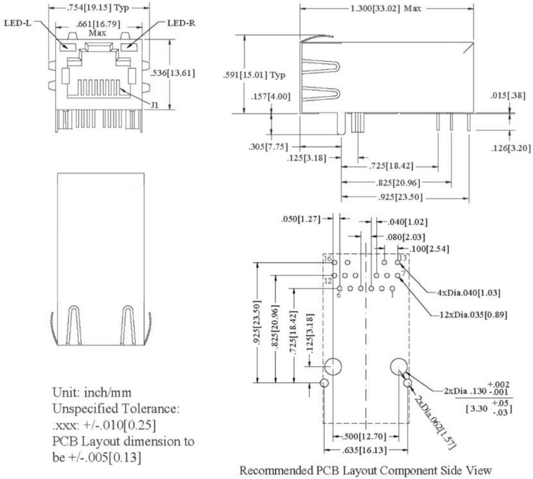
图 2 USR-K2 尺寸图
