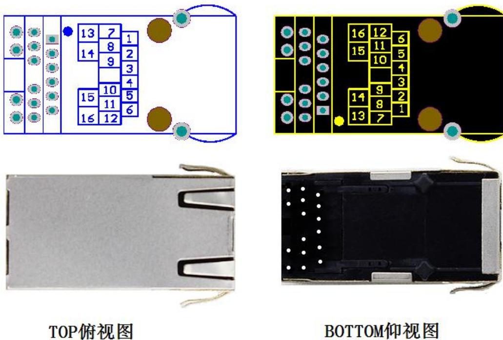
图 1 USR-K2 引脚示意图
