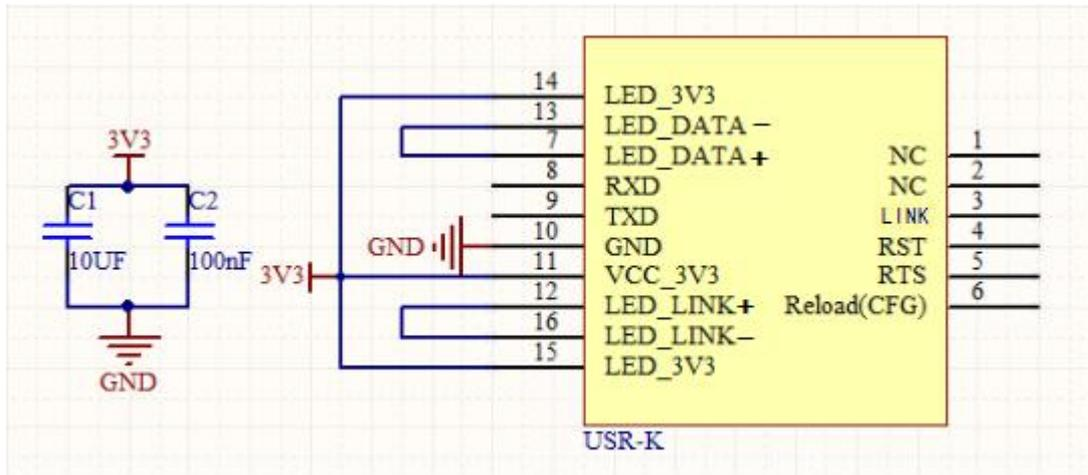
图 4 USR-K2 硬件连接原理图
