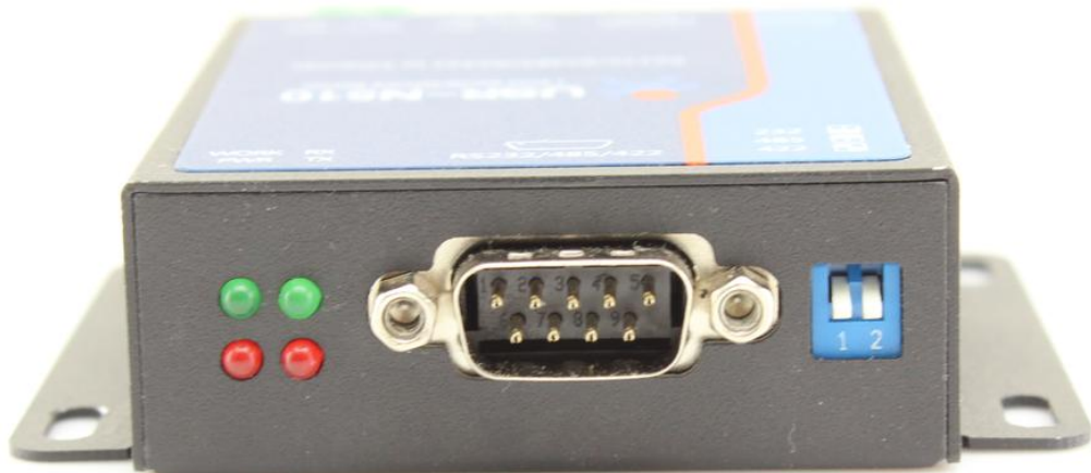
图 7 拨码开关 RS232 状态
