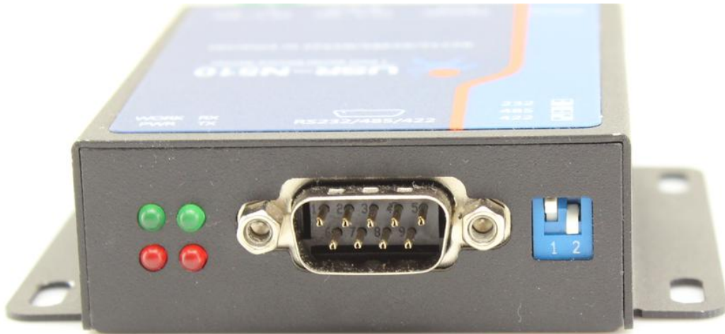
图 9 拨码开关 RS422 状态
