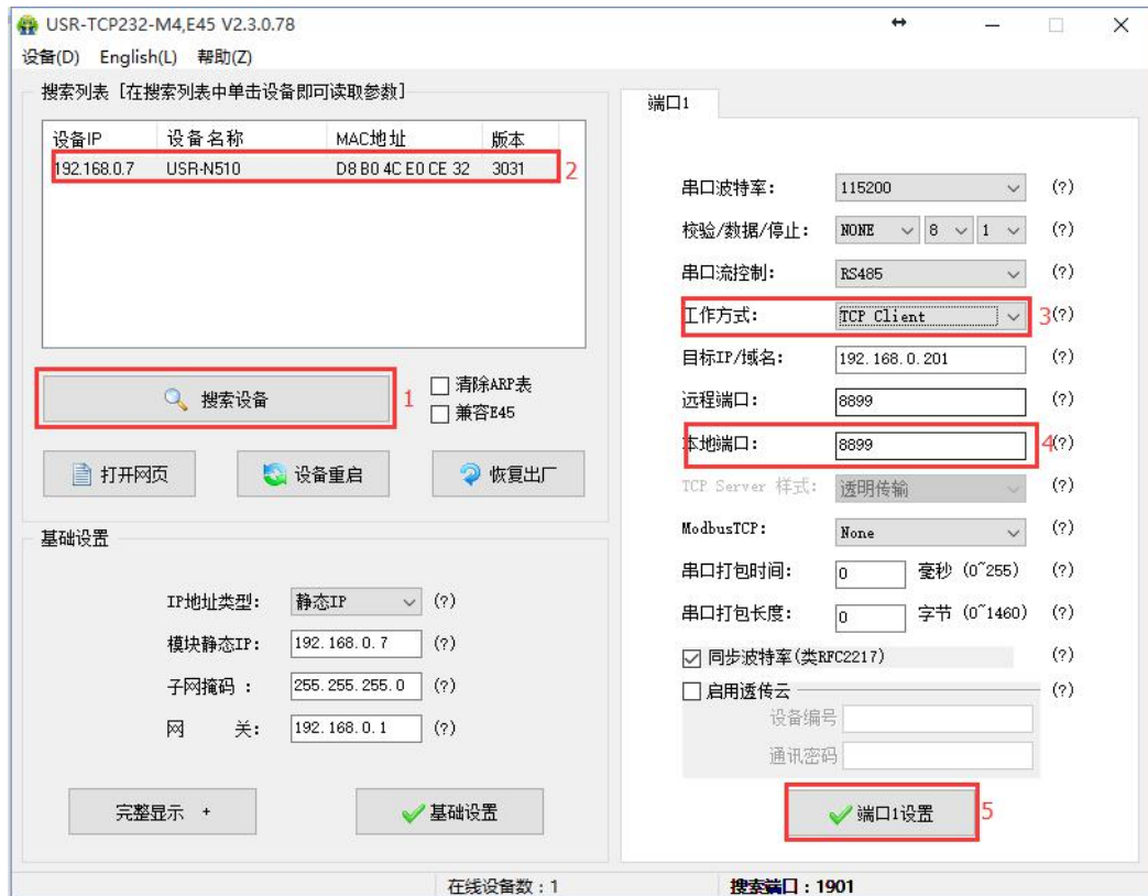
图 6 设置软件设置参数
