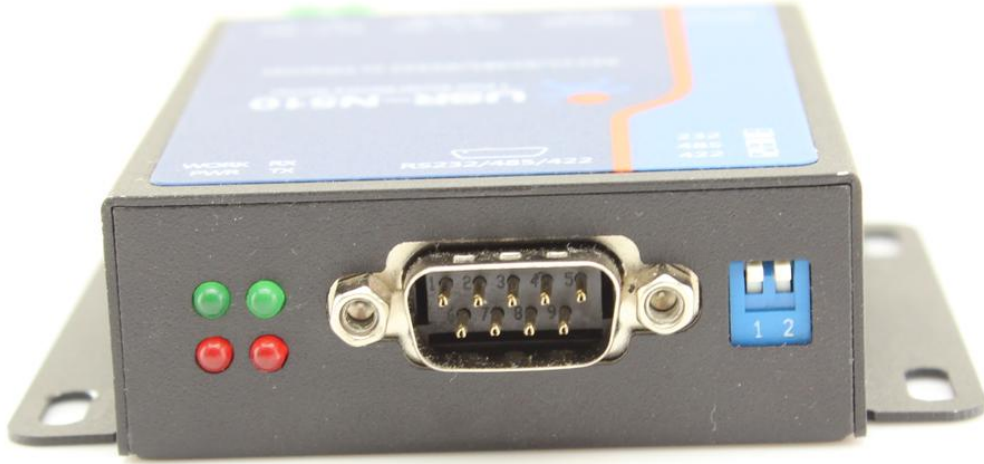
图 8 拨码开关 RS485 状态
