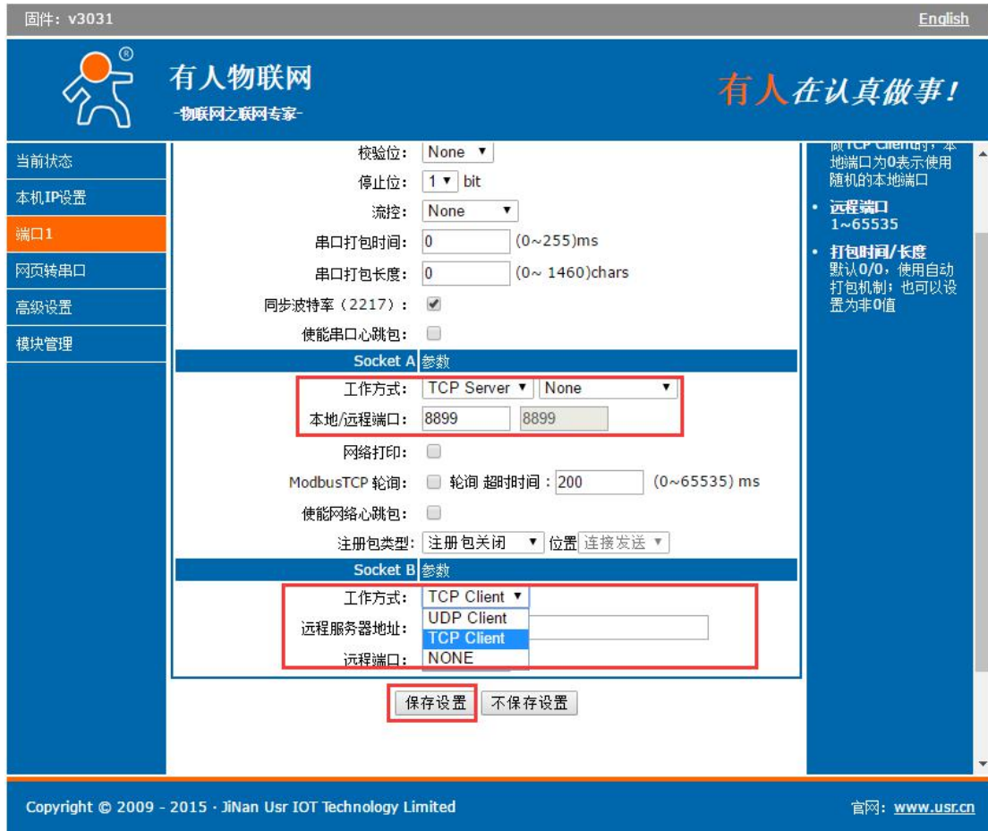
图 4 Socket A/SocketB 设置方法
