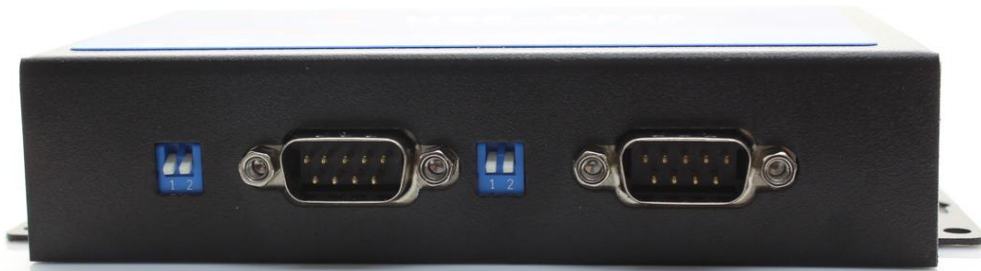
图 11 拨码开关 RS232 状态
