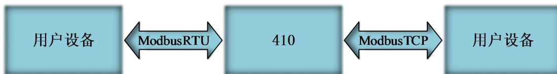
图 8 Modbus RTU 转 ModbusTCP 结构图
