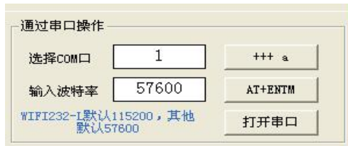
图 27 设置软件串口参数示意图
