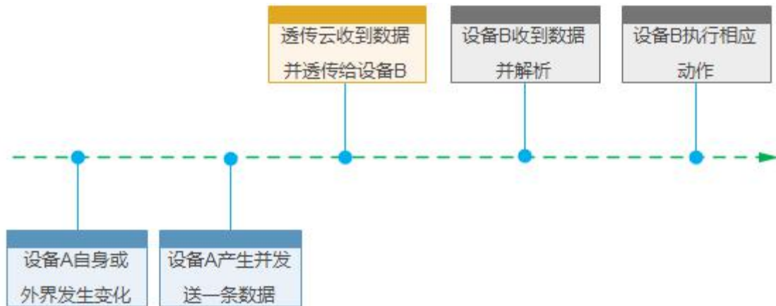
图 13 数据转发流程
