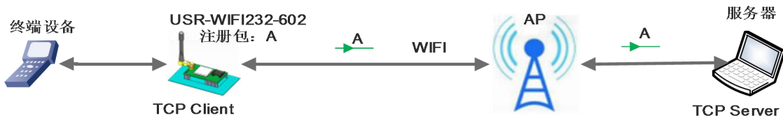
图 22 首次连接发送注册包框图
