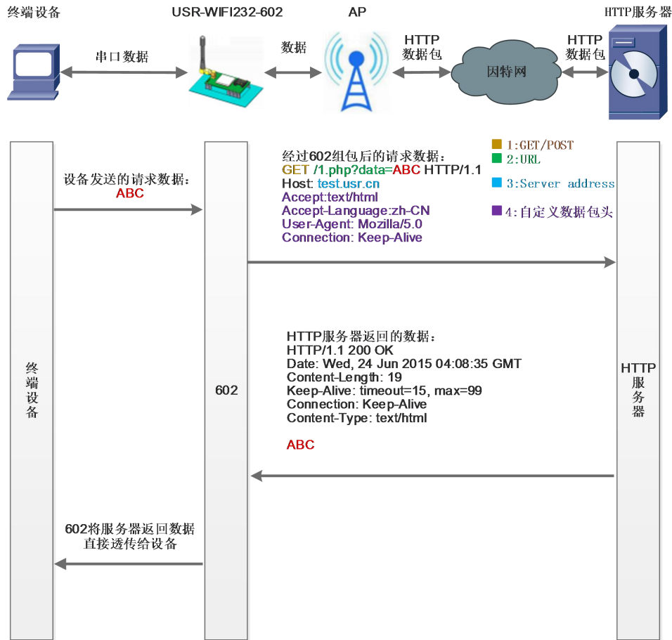
图 15 HTTPD Client 功能框图
