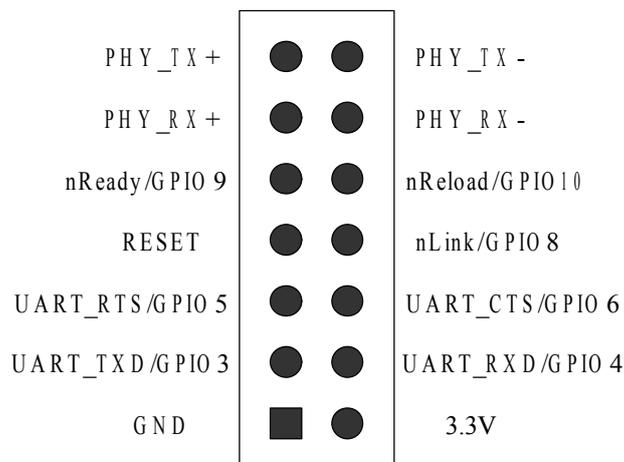
图 5 USR-WIFI232-A 模块硬件接口定义
