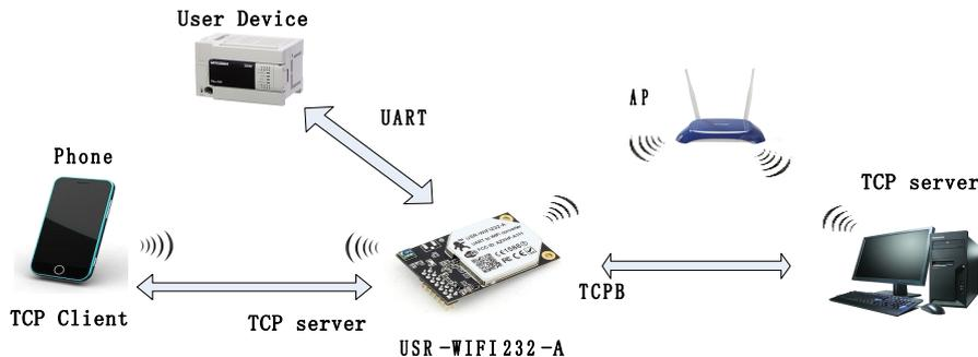
**图 10 AP+STA 方式的无线网络**
