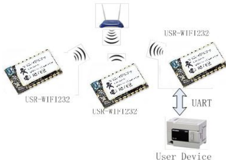
图 2 USR-WIFI232-S 基础网络组网
