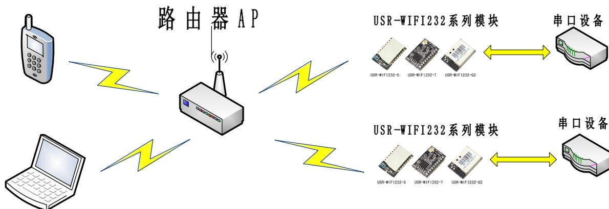
Figure 28 USR-WIFI232-S/T/G2 的 STA 组网结构 (STA)
