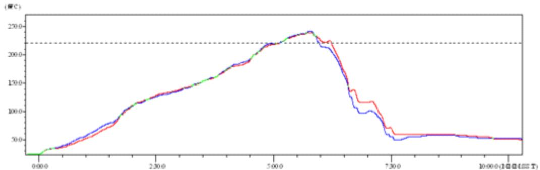
Figure 8 回流焊焊接温度曲线图
