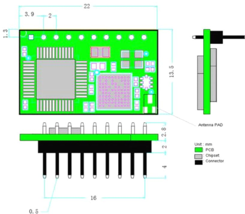
Figure 18 USR-WIFI232-T 机械尺寸
