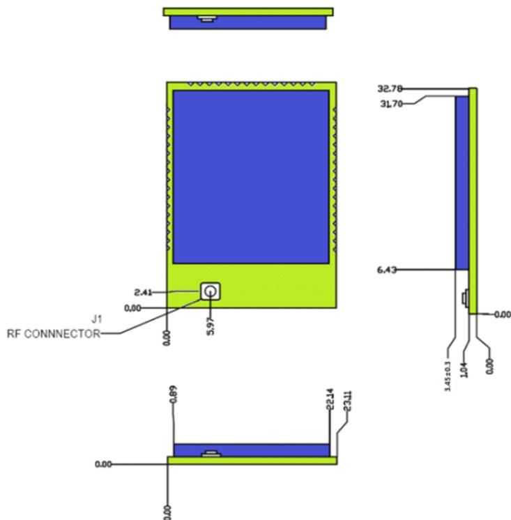
Figure 19 USR-WIFI232-G2 机械尺寸
