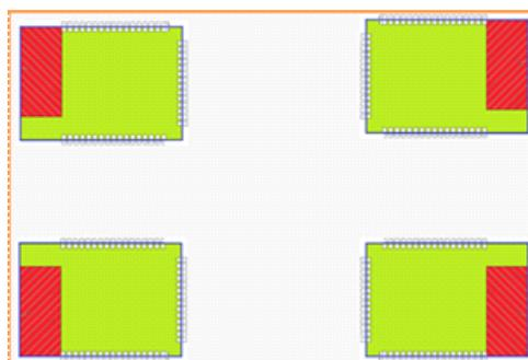
Figure 23 USR-WIFI232-G2a 模组建议放置区域
