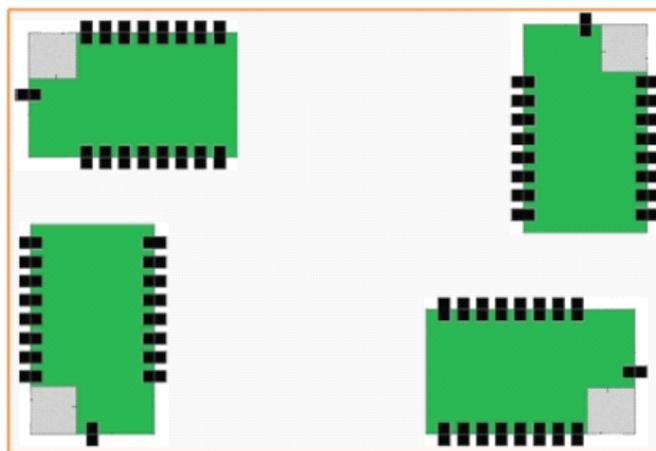
Figure 21 USR-WIFI232-Sa 模组建议放置区域
