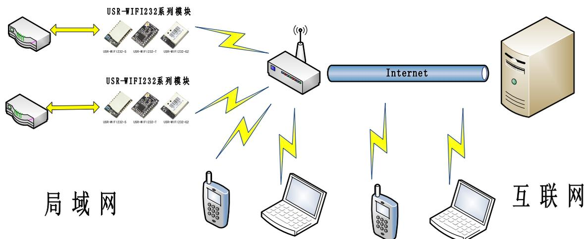
Figure 6 远程连接应用图示
