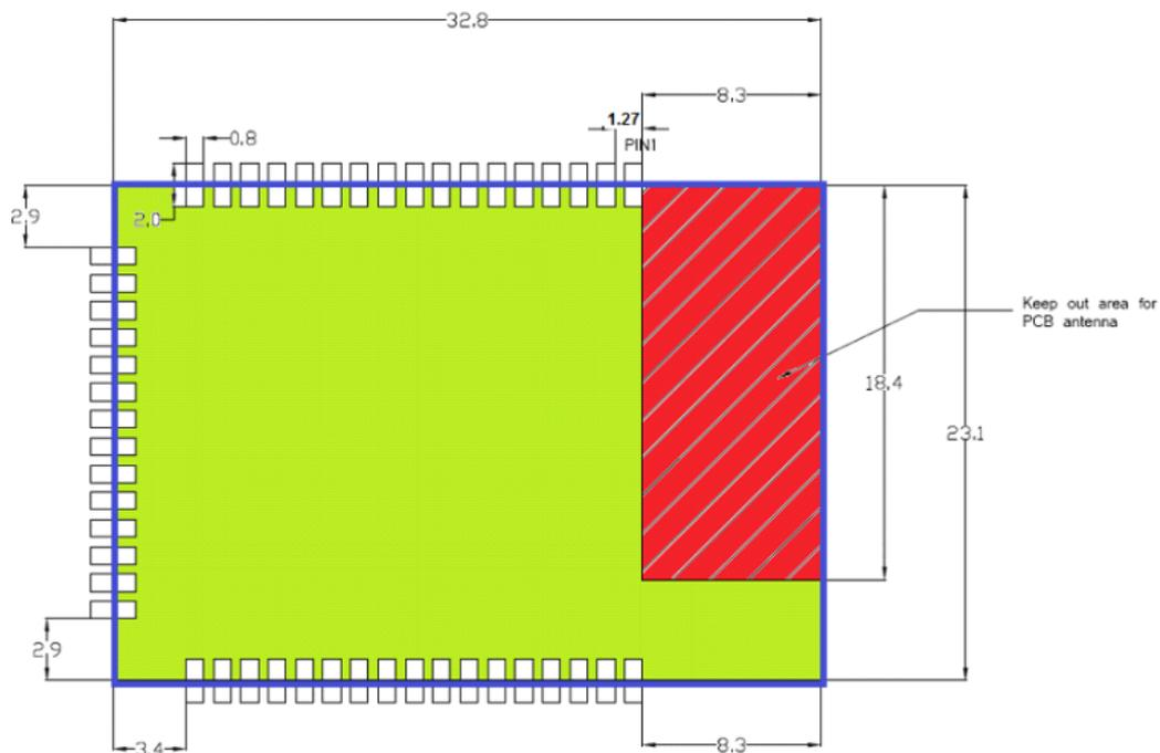
Figure 20 USR-WIFI232-G2 PCB 元件尺寸
