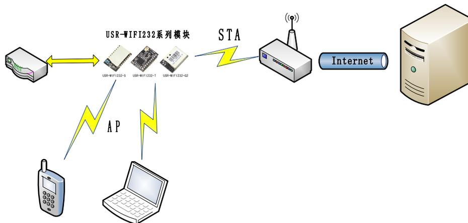
Figure 30 USR-WIFI232-S/T/G2 的 AP+STA 组网结构
