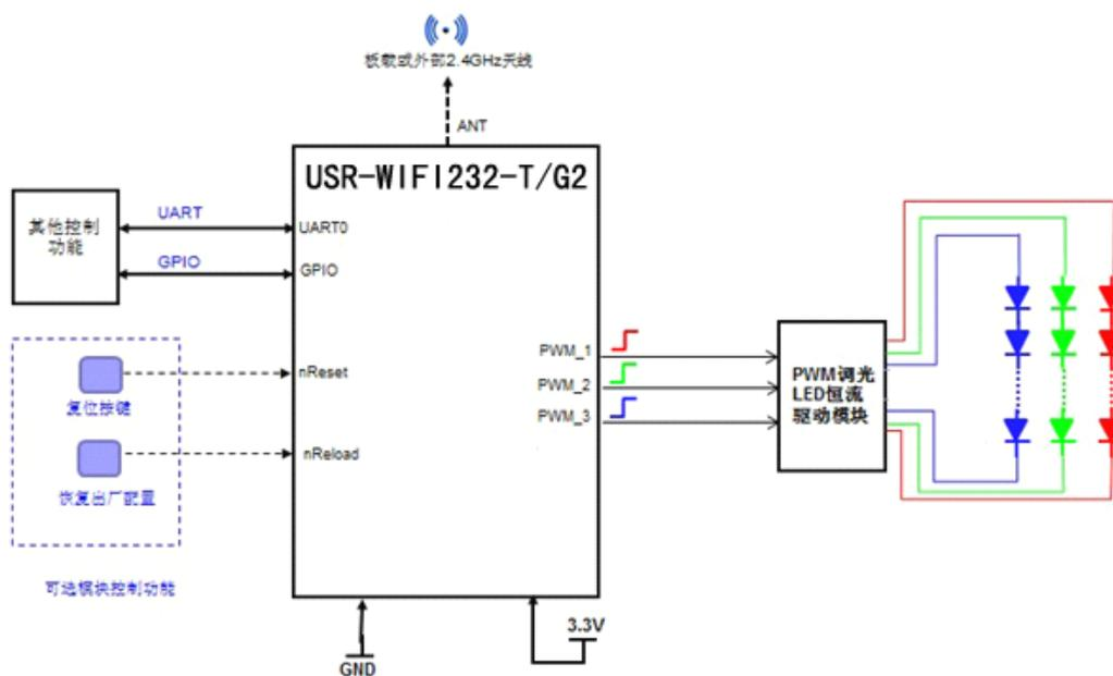
Figure 26 USR-WIFI232-T/G2 智能 LED 应用硬件连接
