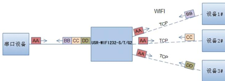
Figure 31 多 TCP 链接数据传输图示
