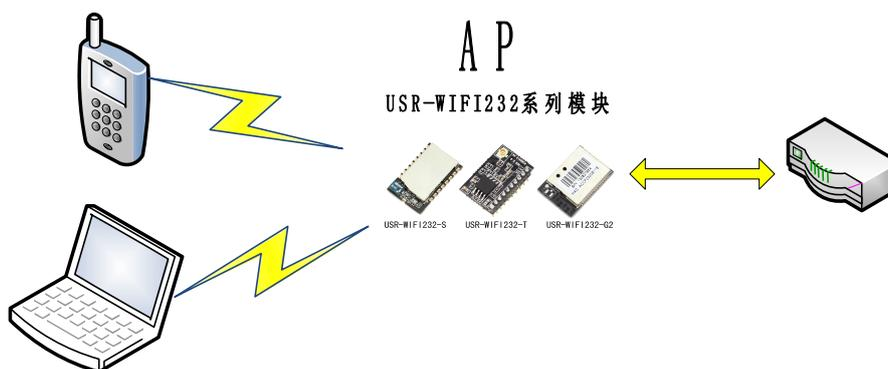
Figure 29 USR-WIFI232-S/T/G2 的 AP 组网结构
