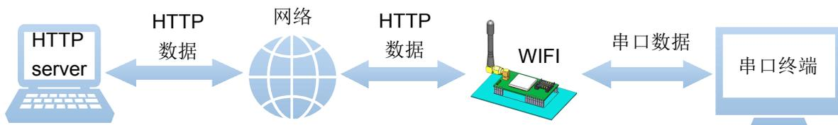
在此模式下，用户的串口设备，可以通过本模块发送请求数据到指定的 HTTP 服务器，然后模块接收来自 HTTP 服务器的数据，对数据进行解析并将结果发至串口设备。
