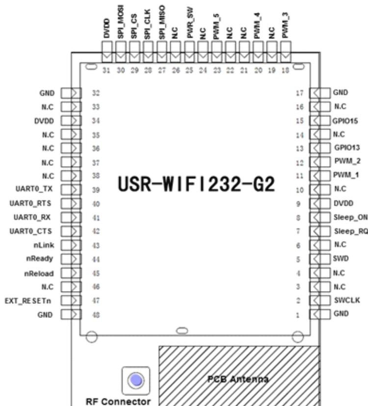
Figure 15 USR-WIFI232-G2 管脚定义
