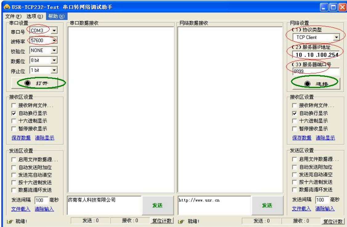
至此,你就可以在串口和网络之间进行数据收发测试了,串口到网络的数据流向是:计算机串口->模块串口->模块 WIFI->计算机网络,网络到串口的数据流向是:计算机网络->模块 WIFI->模块串口->计算机串口。
