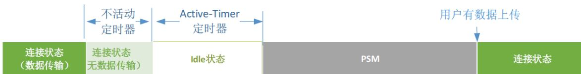
首先，连接状态中数据传输对应 Connected 发射电流，数据发送完成后进入无数据传输的连接状态，此时对应 Connected 接收电流，这部分存在一个不活动定时器，这个定时器有核心网配置，目前约 20 秒时间，随后进入 IDLE 模式，在该模式中存在一个 Active 定时器，这个定时器在上面章节有过描述，有运营商通过 APN 可以配置，该定时器到达时间后进入 PSM 状态。
