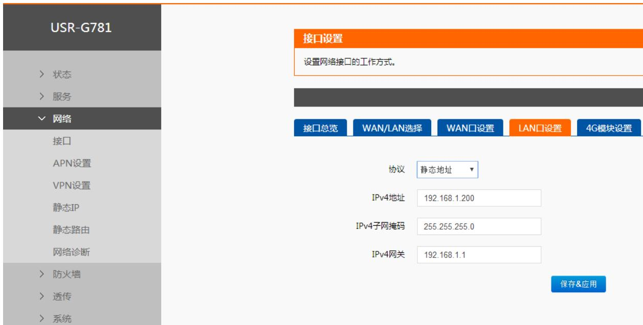
图 13 LAN 口设置 DHCP 服务器
