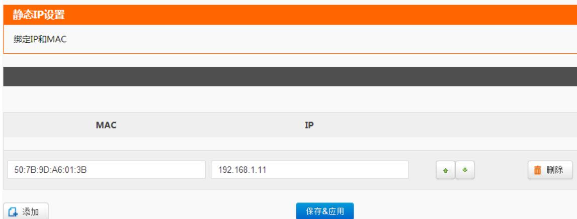
图 21 静态 IP 绑定设置方法
