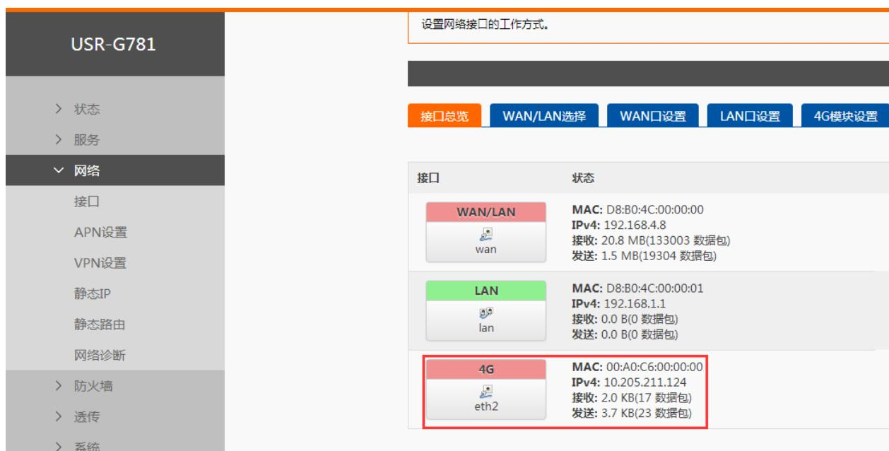
该图展示了 USR-G781 的 Web 管理界面中的“接口状态”页面。左侧是一个垂直菜单栏，包含“状态”、“服务”、“**网络**”（展开）、“接口”、“APN设置”、“VPN设置”、“静态IP”、“静态路由”、“网络诊断”、“防火墙”、“透传”和“系统”。右侧上方显示了“设置网络接口的工作方式。”下方是“接口总览”、“WAN/LAN选择”（当前选中）、“WAN口设置”、“LAN口设置”和“4G模块设置”。右侧下方是一个表格，列出了三个接口的状态：
