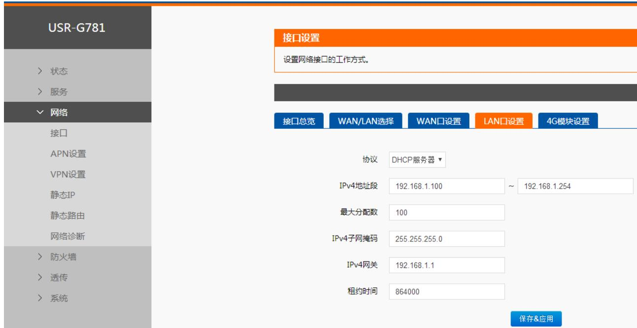
图 12 LAN 口设置 DHCP 服务器
