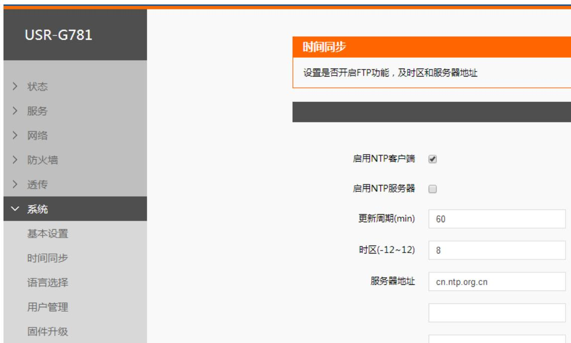
图 28 时间同步 (NTP) 设置
