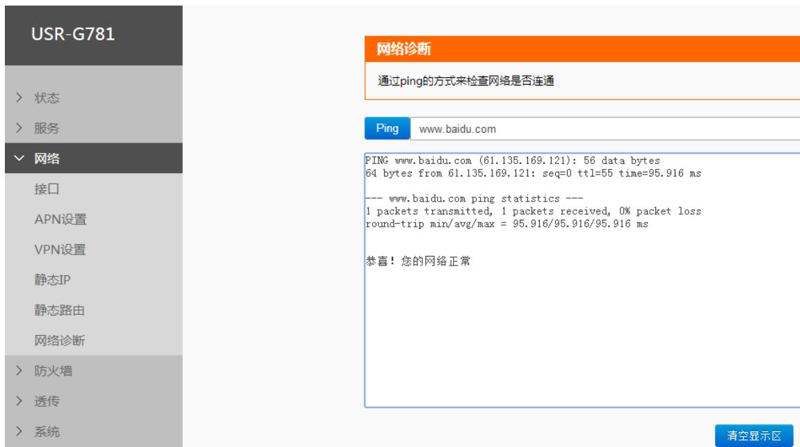
图 23 网络诊断使用方法
