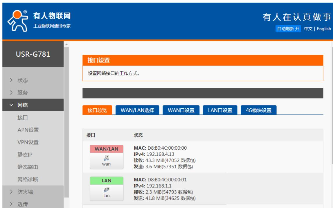
USR-G781 网络设置界面。左侧导航栏显示：状态、服务、**网络**（展开）、接口、APN设置、VPN设置、静态IP、静态路由、网络诊断、防火墙（展开）、透传。右侧主区域标题为“接口设置”，子标题“设置网络接口的工作方式。”下方有“接口总览”、“WAN/LAN选择”、“WAN口设置”、“LAN口设置”、“4G模块设置”五个选项卡，“WAN/LAN选择”被选中。显示了两个端口的状态：
