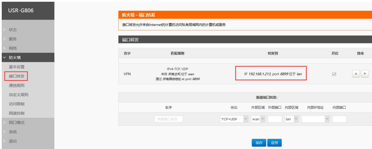
图 103 端口映射设置页面
