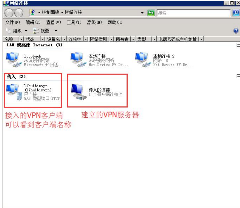
图 50 PC 连接 VPN 操作七
