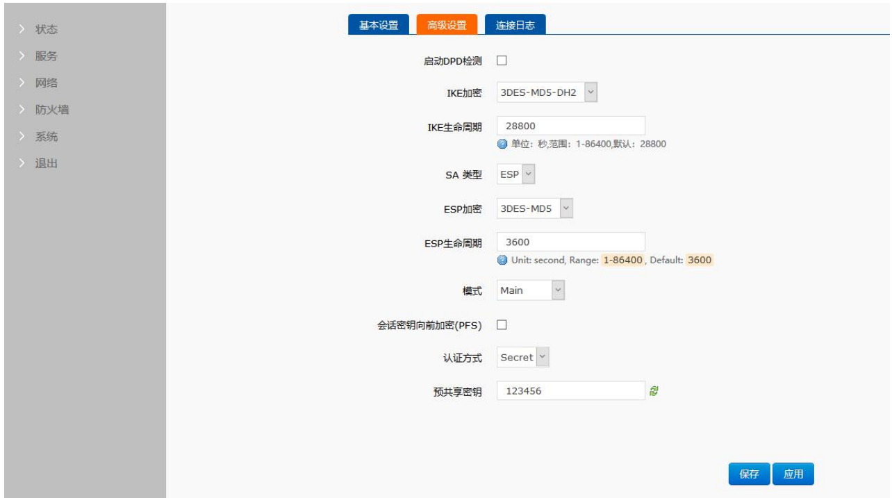
图 75 IPSEC 主模式配置举例
