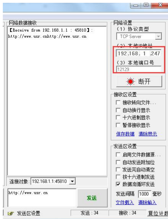
图 122 4G 网络端口映射测试
