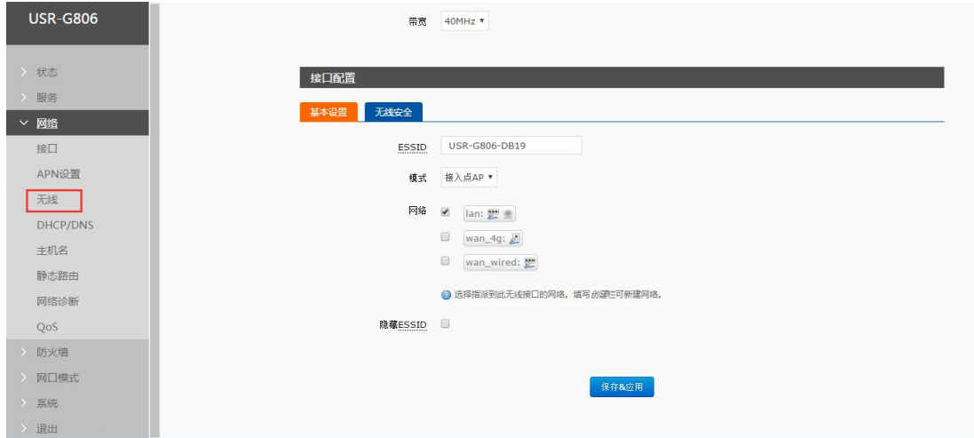
图 32 SSID 设置页面
