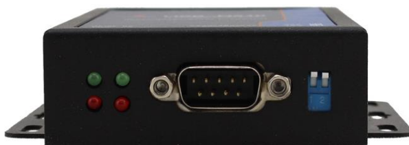
图 10 拨码开关 RS485 状态
