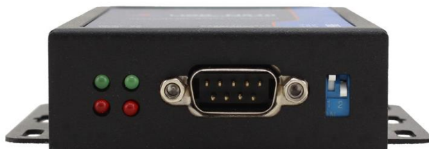
图 11 拨码开关 RS422 状态
