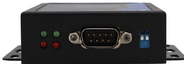
图 9 拨码开关 RS232 状态
