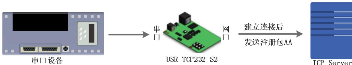
**图 29. 建立连接发送注册包**
