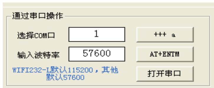
图 53 设置软件串口参数示意图
