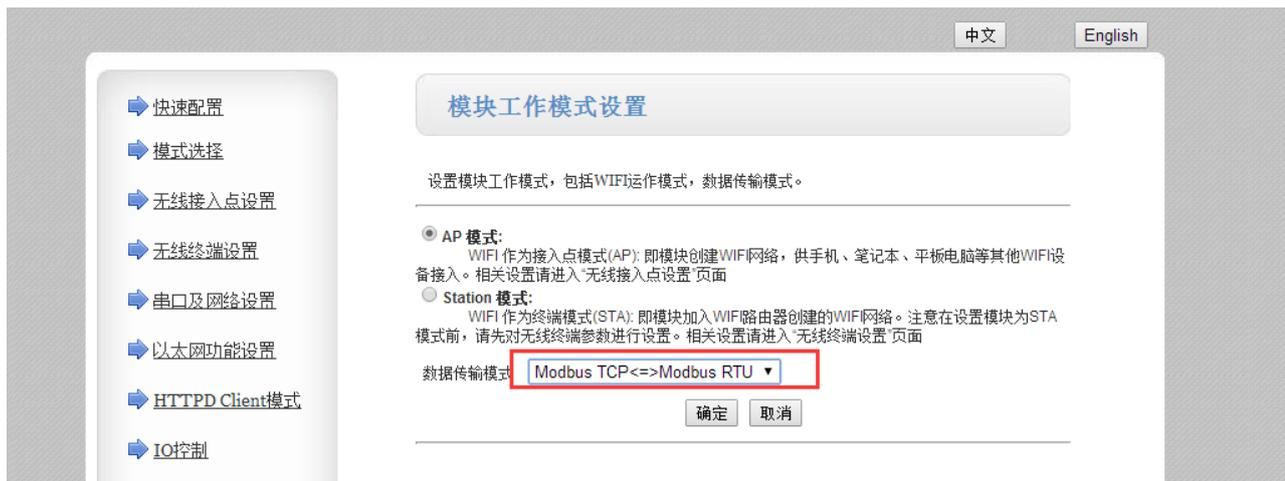
图 17 MODBUS TCP $\leftrightarrow$ MODBUS RTU 模式选择
