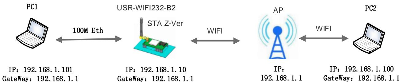
图 11 USR-WIFI232-B2 以太网接口功能（STA Z-Ver）
