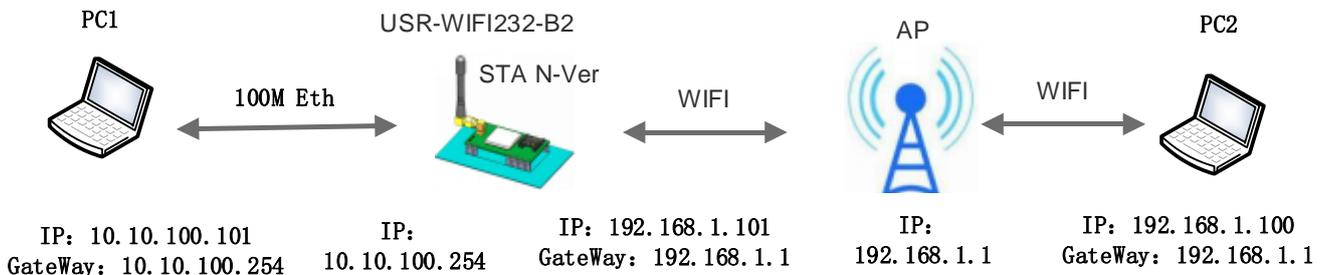
图 10 USR-WIFI232-B2 以太网接口功能 (STA N-Ver)
