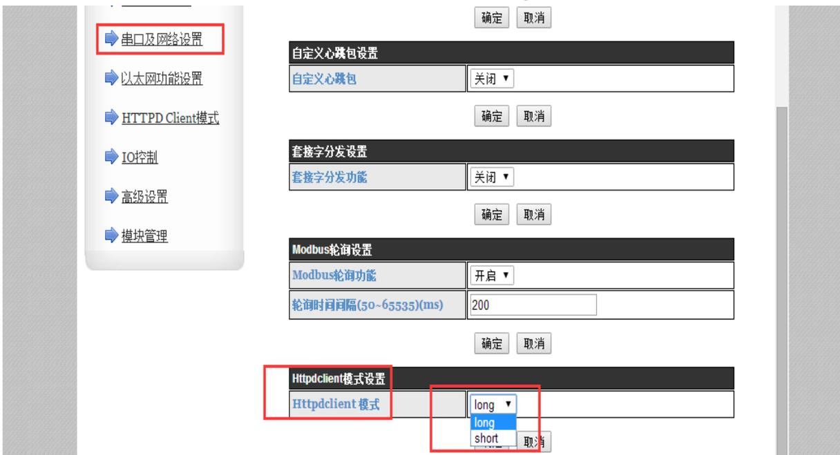
**图 13 HTTPD Client 短连接**
