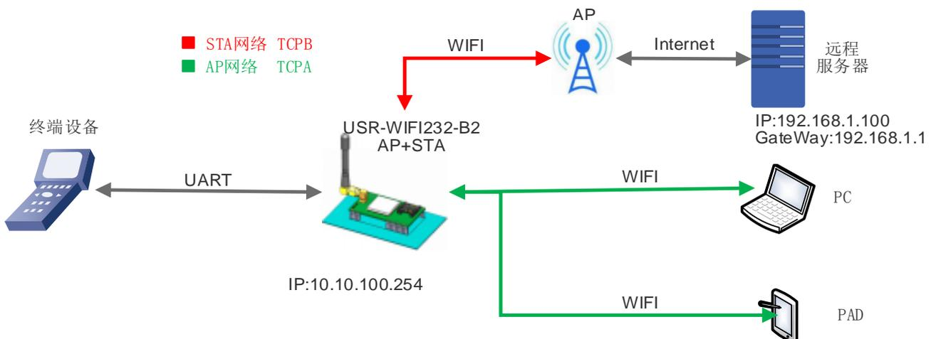
图 7 AP+STA 方式的无线网络
