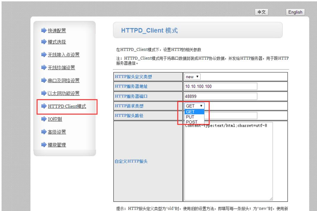
图 15 HTTPD Client 工作方式设置
