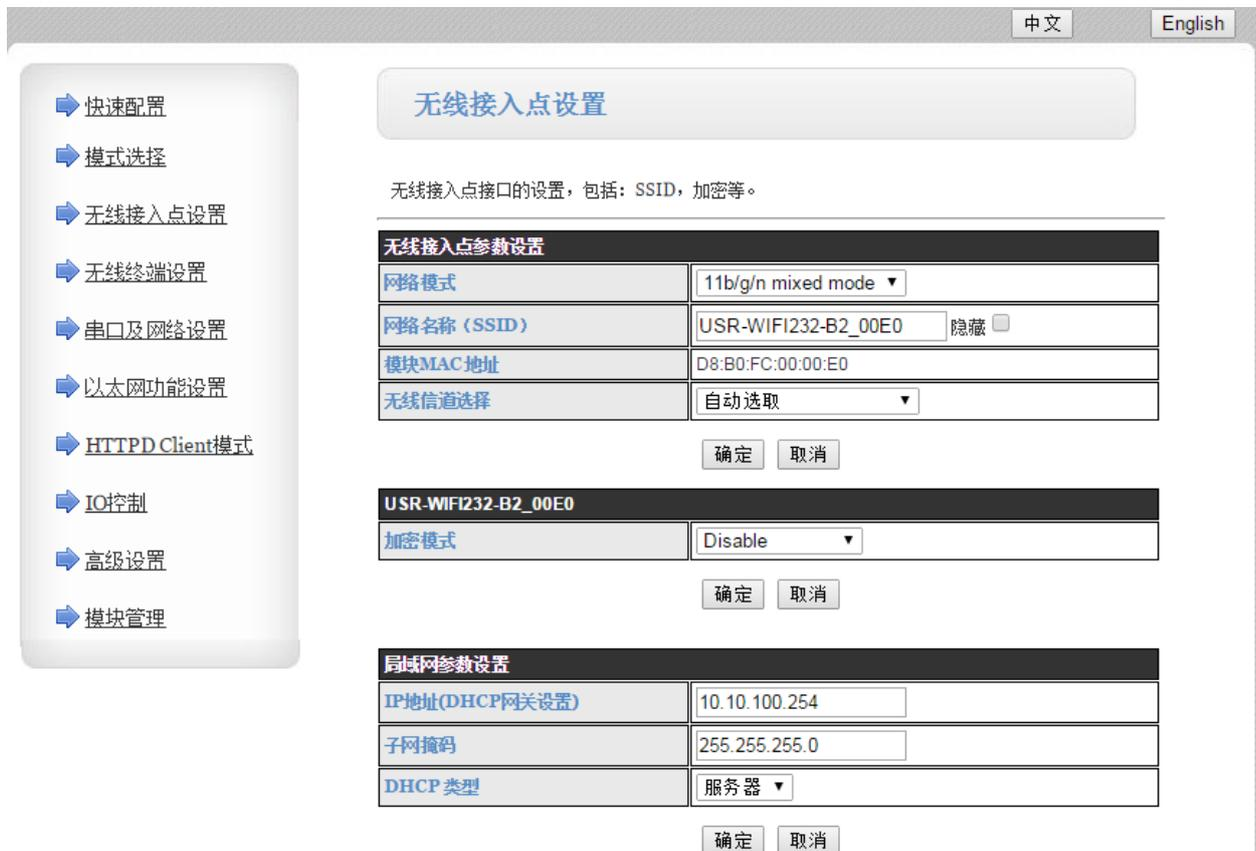
图 40 无线接入点设置
