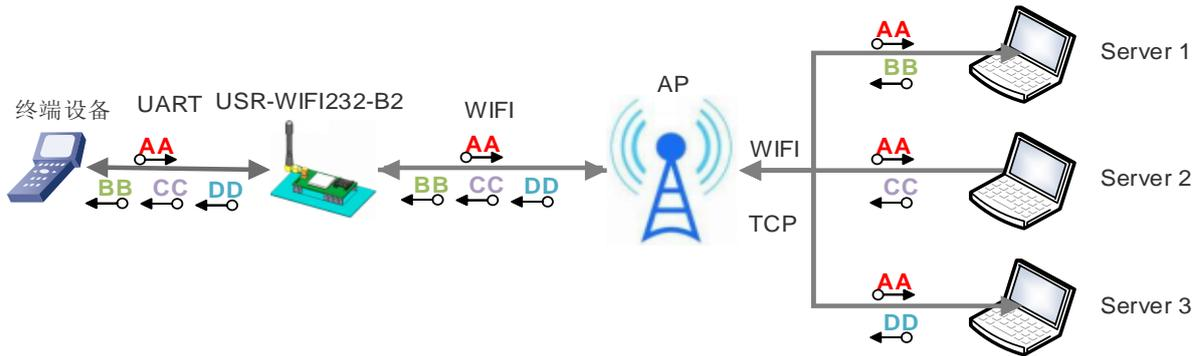
图 18 多 TCP 链接数据传输图示
