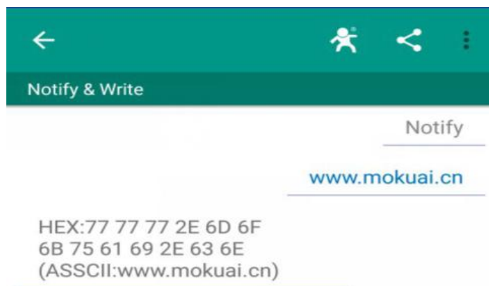
图 6. 模块数据传输示意图
