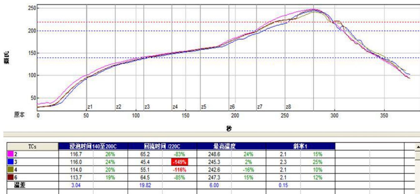
图片18 回流焊焊接温度曲线图
