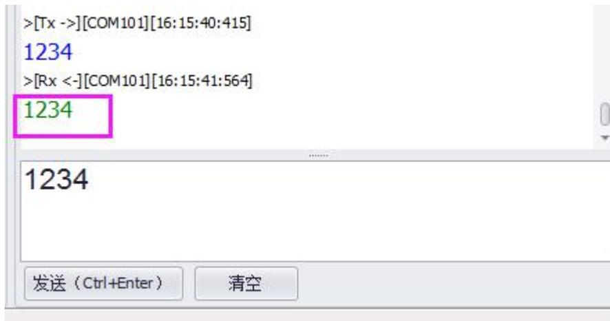
**注意:** 模块向服务器发送完数据后会进入 PSM 模式, 进入该模式后不能再接收到服务器下发的数据, 所以向下发送数据需要在没有休眠的时候立即下发才能收到。如果不需要低功耗功能, 可以关闭 PSM 功能, 这样可以实现实时的数据下发, 详细内容请参考《WH-NB73\_低功耗机制与业务场景说明》, 链接如下:
