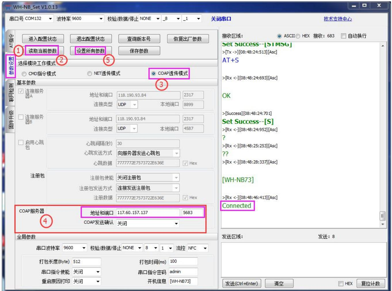
**注意：**重启之后模块进入 CoAP 透传模式，如需进行参数配置则需要先进入配置状态后才能发送 AT 指令对参数进行配置。
