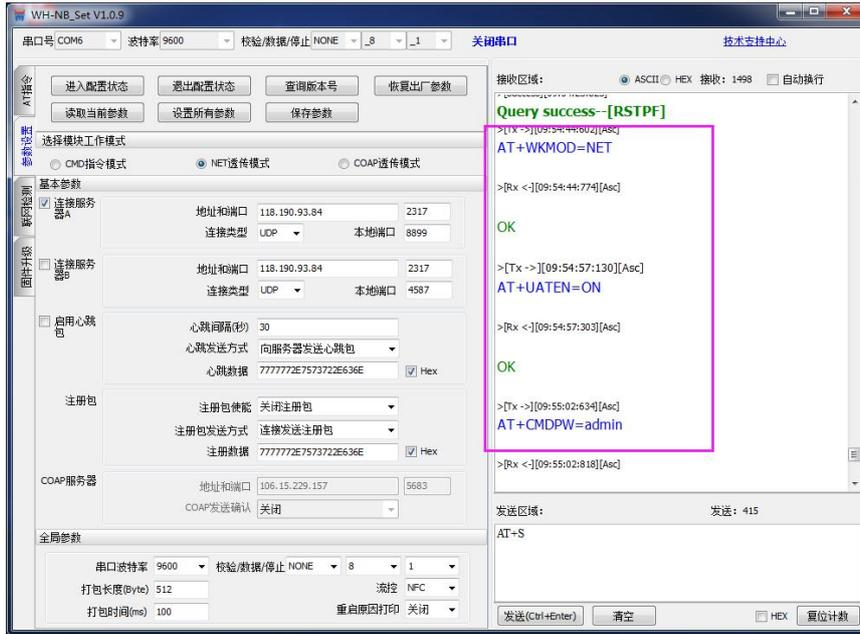
以上为准备工作，可以通过设置软件实现，完成上面的设置后，即可在透传模式下实现串口 AT 指令。
