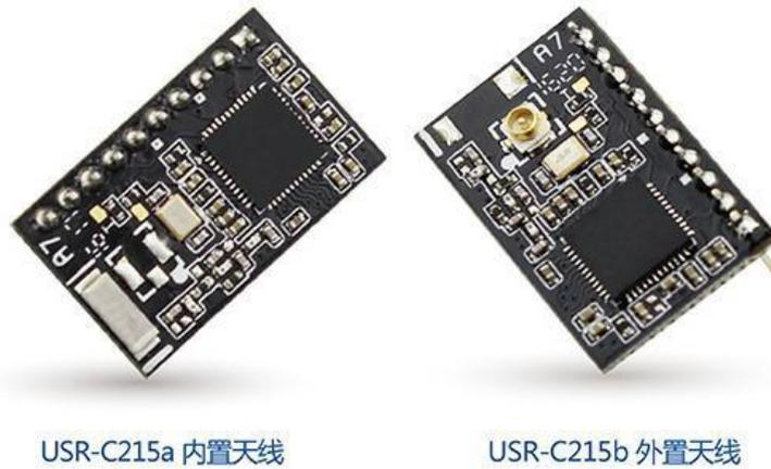
图 6 USR-C215 封装图
