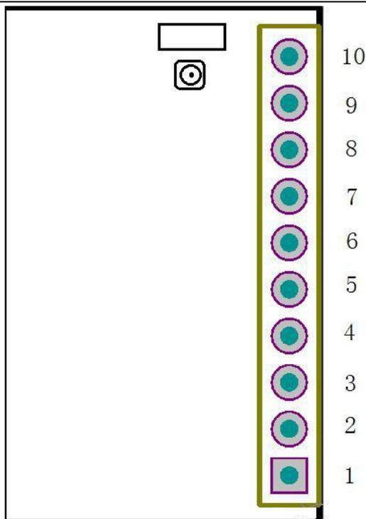
图 8 USR-C215 引脚图
