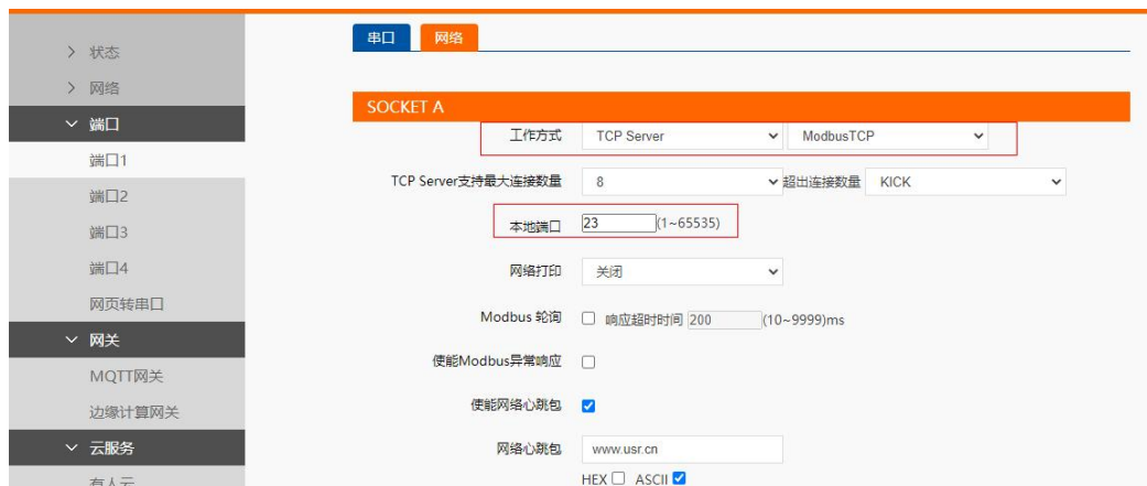
图 61 Modbus RTU 转 Modbus TCP
