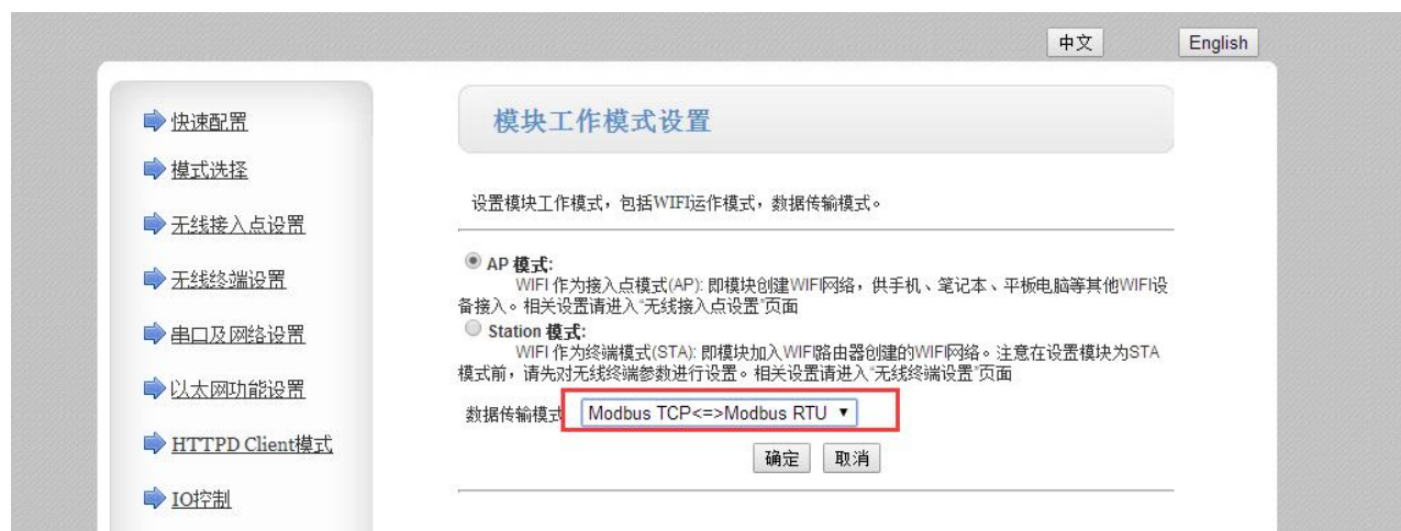
图 17 MODBUS TCP \leftrightarrow MODBUS RTU 模式选择
