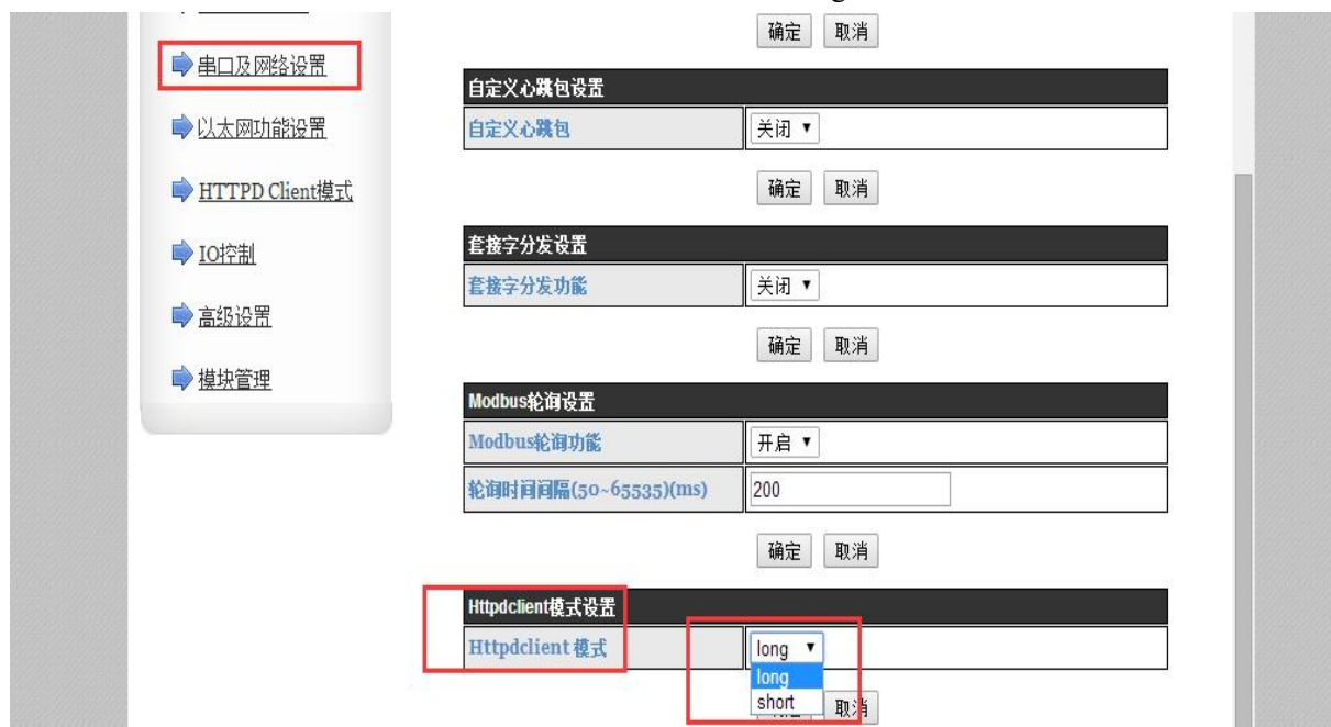
图 13 HTTPD Client 短连接
