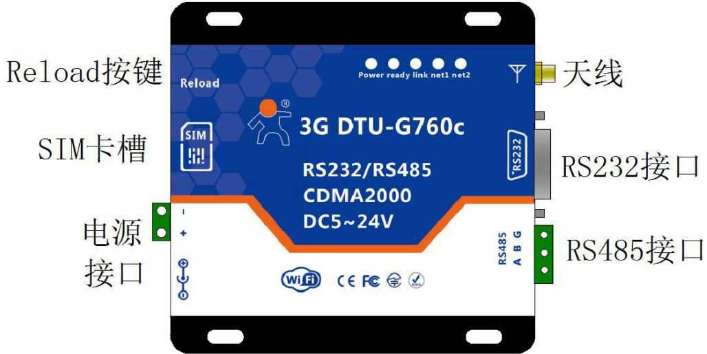
图 2 USR-G760c 硬件接口示意图
