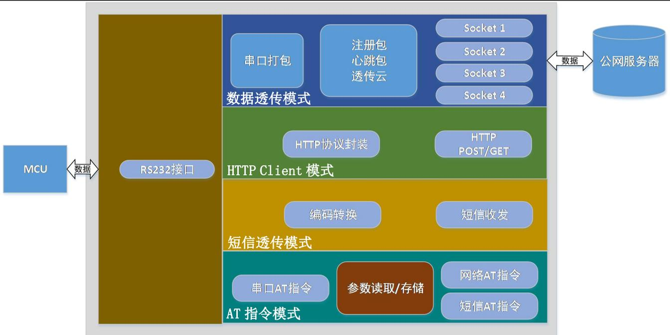
图 1 USR-GPRS-701-2 功能框图
