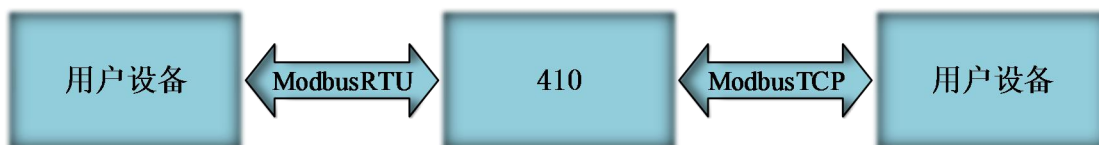
图 7 Modbus RTU 转 ModbusTCP 结构图
