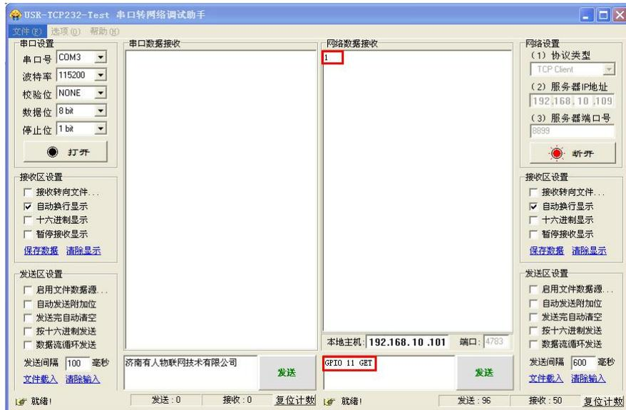
图 23 查询 GPIO 电平
