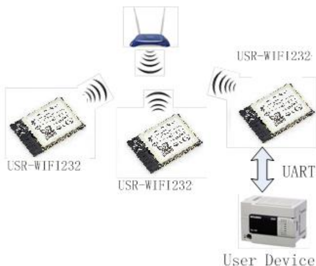
图 10 USR-WIFI232-G2 基础网络组网
