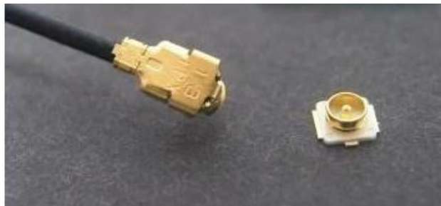
图 8 USR-WIFI232-T 外置天线接头示意图
