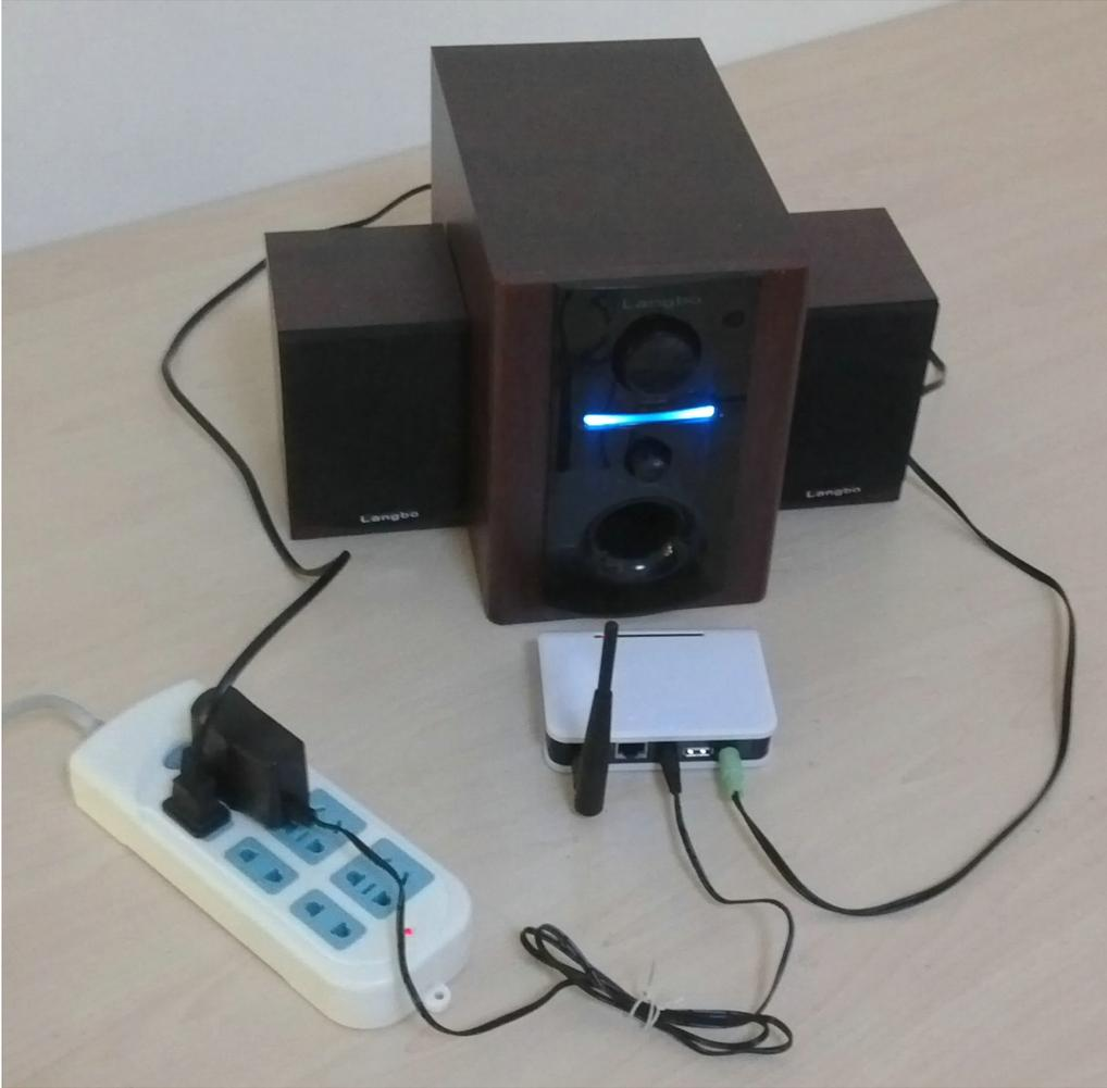
产品对外接口自左到右依次是：天线接口、恢复出厂设置按键、网口、DC5V 电源接口、USB 供电口、音响/耳机接口（）如下图。对应顺序依次接好就可以了。
