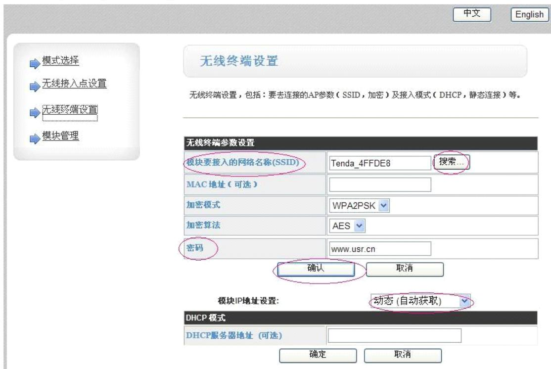
在“模块要接入的网络名称(SSID)”填入要加入的路由器的名称，也可以通过“搜索”按钮搜索周围无线网络并加入网络，在“密码”栏中填入路由器的无线密码。
