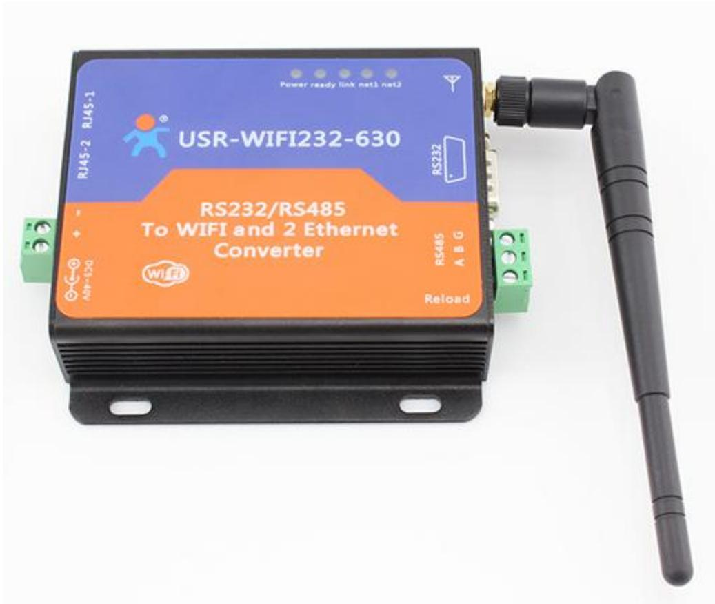
WIFI 双网口串口服务器提供串口转 WIFI、串口转以太网、以太网转 WIFI 功能，能够将 RS-232/485 串口转换成 TCP/IP 网络接口，实现 RS-232/485 串口与 WIFI/以太网的数据双向透明传输。使得串口设备能够立即具备 TCP/IP 网络接口功能，连接网络进行数据通信，极大的扩展串口设备的通信距离。
