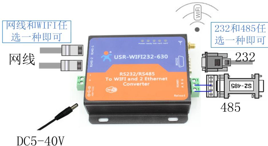
图 1 硬件连接图
