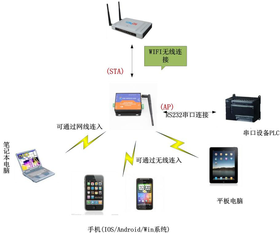
1、将模块的 AP+STA 模式打开: 发送 AT 指令 AT+FAPSTA=on 和 AT+FVER=z 到模块, 收到正确回应后, 恢复出厂设置。
