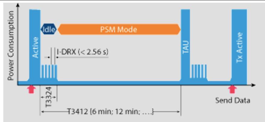
下面是我的电信 SIM 卡的 TAU 是 10 分钟，那么对应的电流显示可以看到每间隔 10 分钟会有一次电流的变化：
