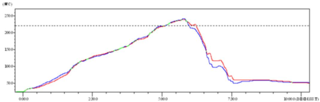
图 1 回流焊焊接温度曲线图
