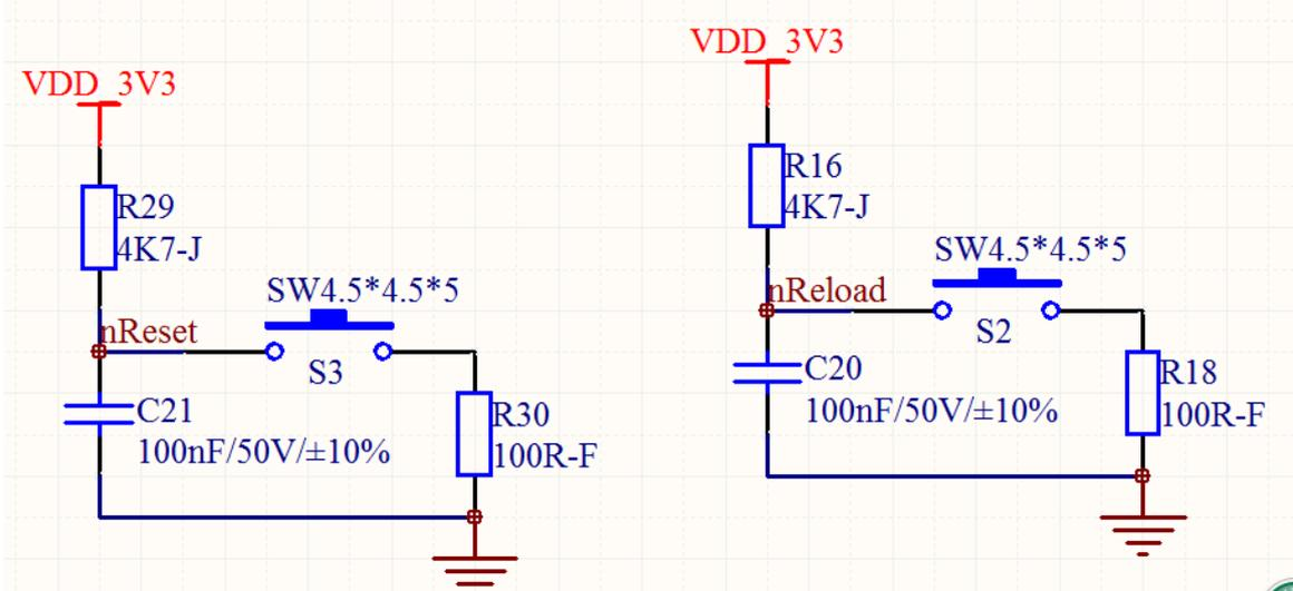
图片 8 nReload 和 nReset 设置控制电路图
