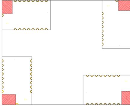
图片 10 USR-C216a 模组建议放置位置示意图
