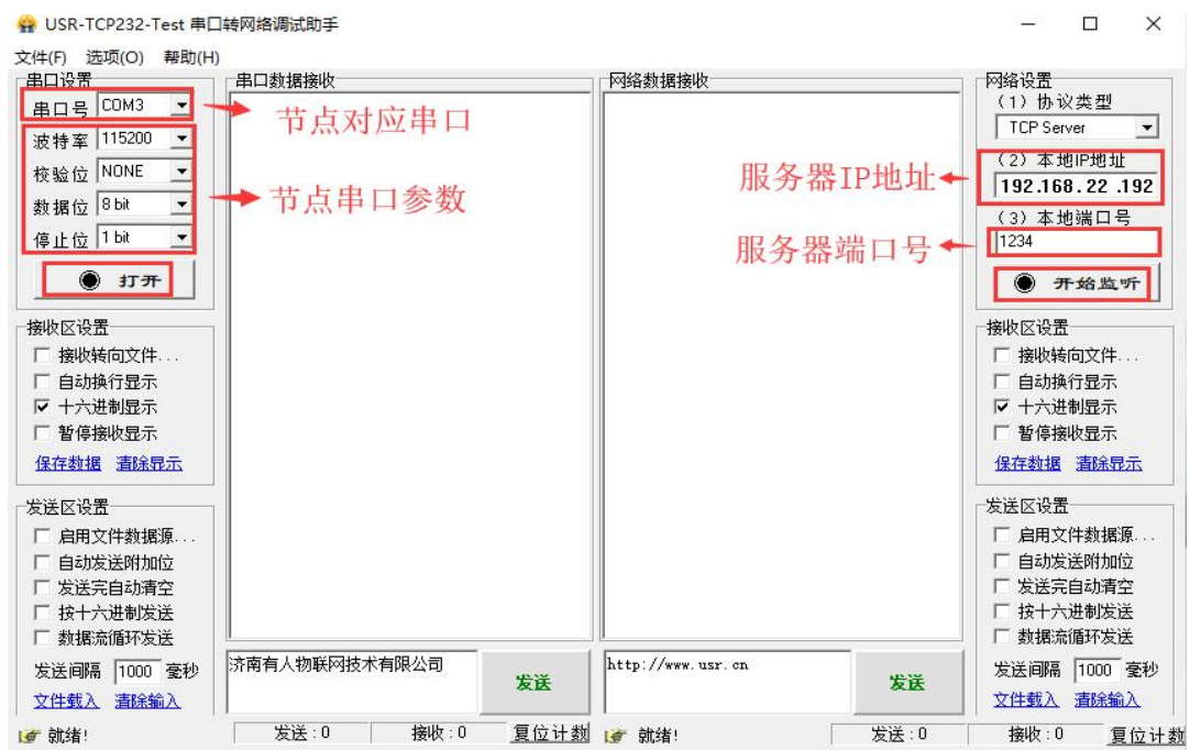
图 5 配置串口和本地服务器
