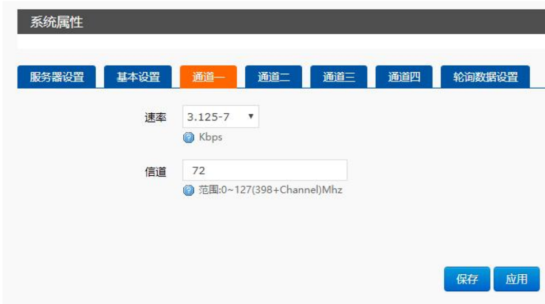
图 11 主动上 Web 数据通道设置参数
