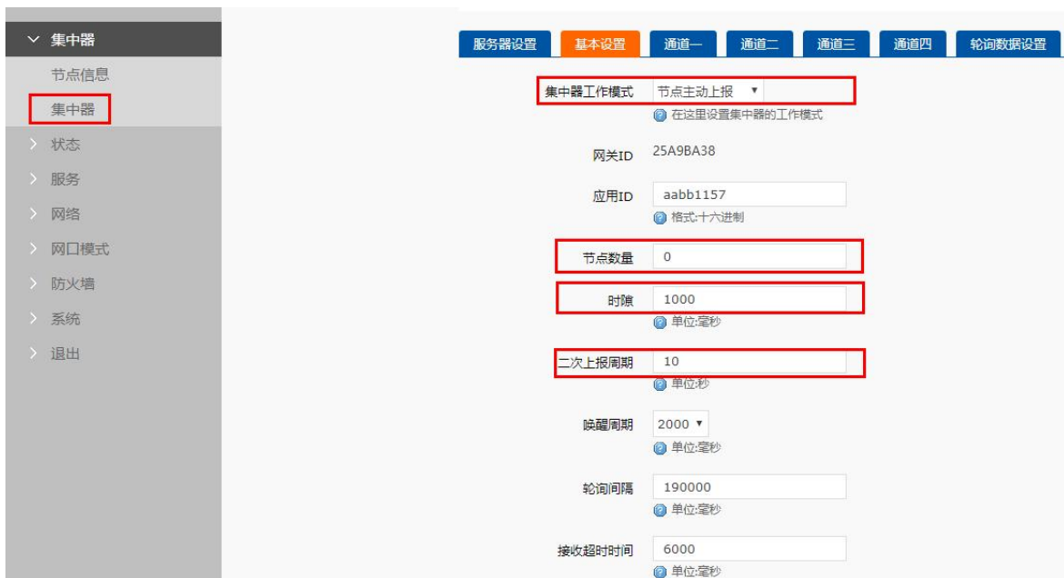
图 10 主动上报 Web 基本设置参数
