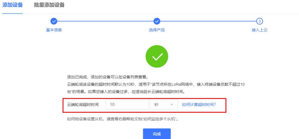
图 31 设置轮询超时
