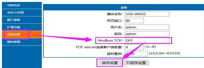
在 Modbus TCP 一栏中填写（不区分大小写）“on”：开启功能，填写“off”：关闭功能，默认关闭。
