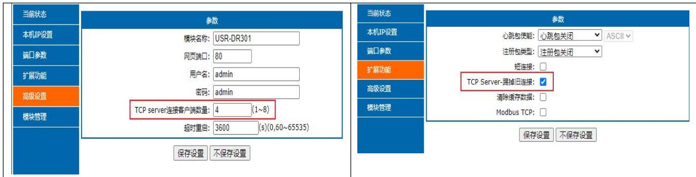
图 37 TCP Server 连接 Client 最大值
