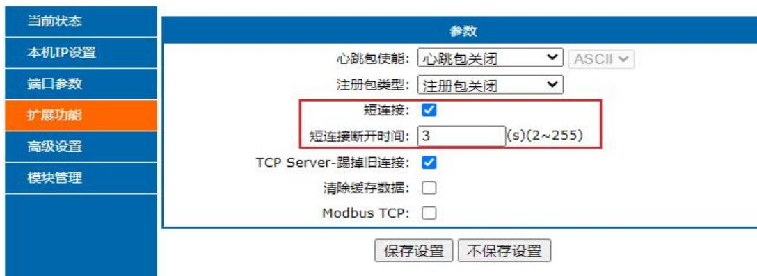
图 38 短连接设置图示
