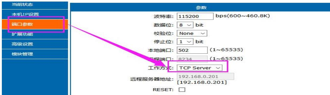
网页开启 Modbus TCP 转 Modbus RTU 功能方法：
