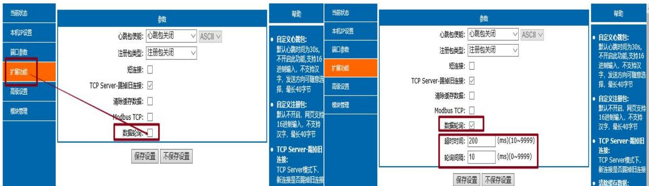
图 41 轮询功能参数设置图示
