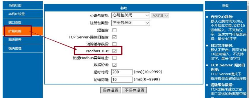
图 42 MODBUS TCP 使能设置图示
