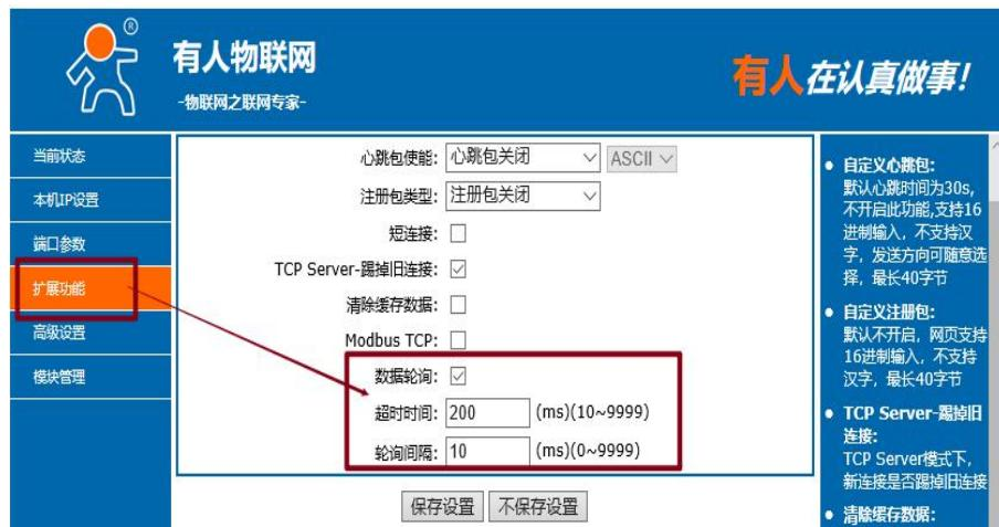
图 45 轮询参数设置图示
