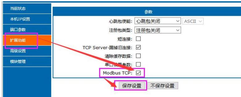
鼠标点击 Modbus TCP 勾选框，勾选，开启功能，取消勾选关闭功能，该功能默认关闭。
