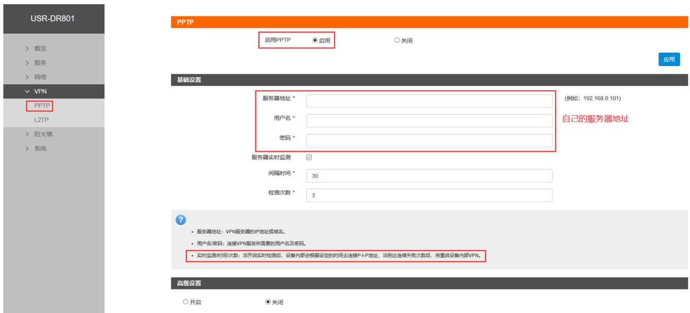
图 45 PPTP 搭建示例：基础设置
