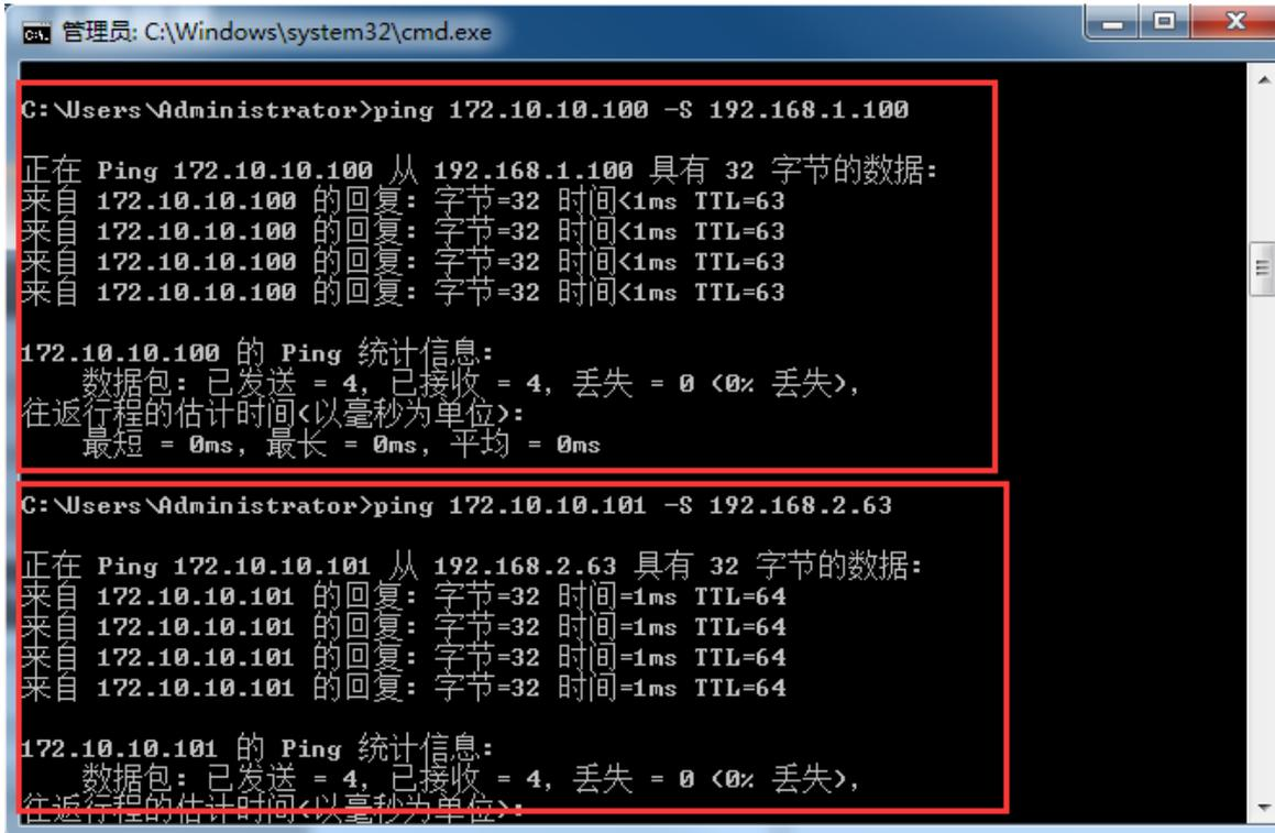
图 49 PPTP 搭建示例：网络互通
