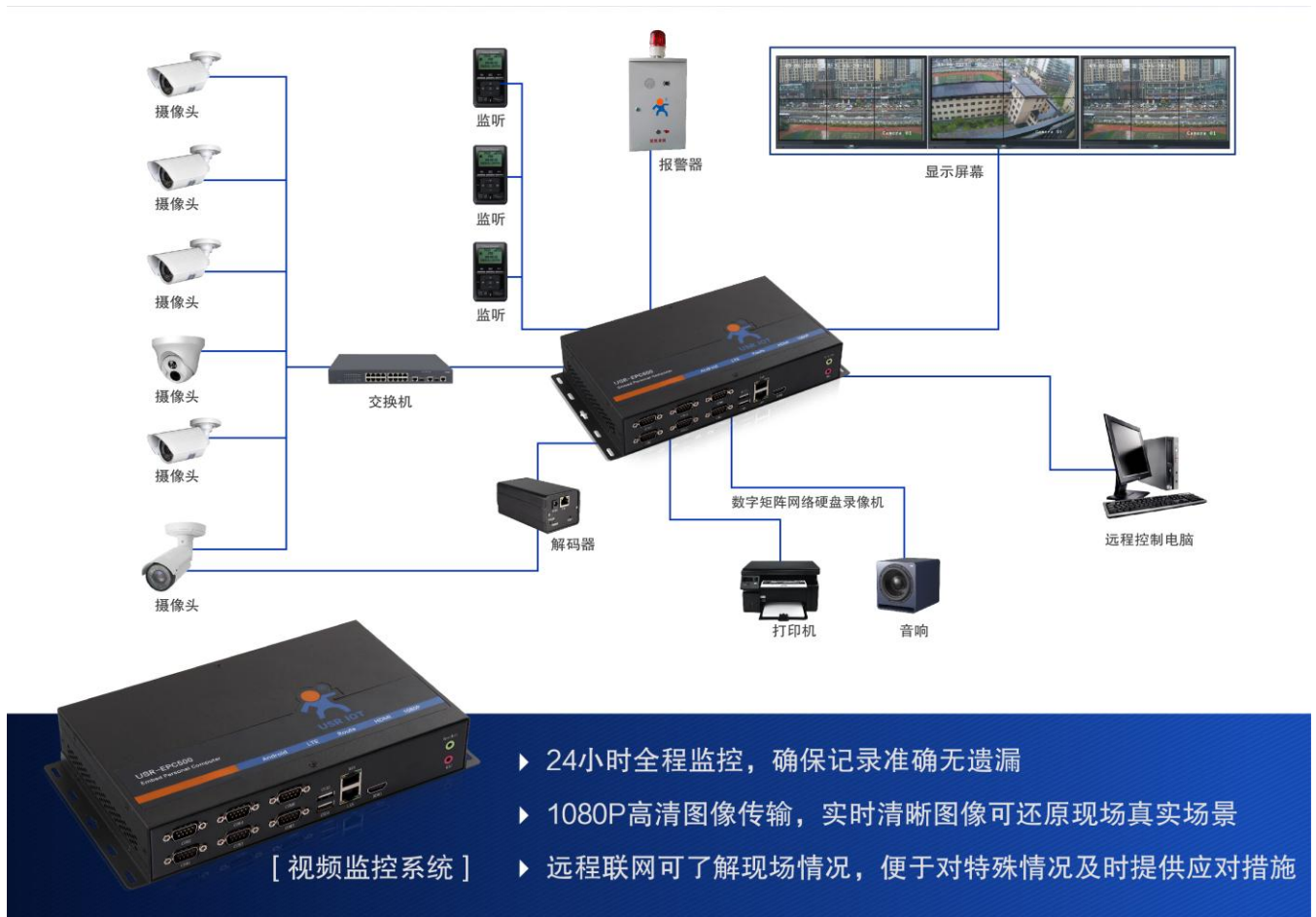
图 25 视频监控系统组件连接图
