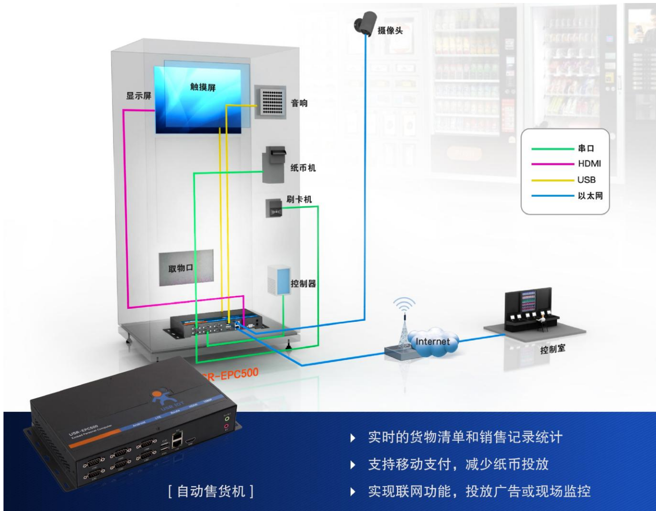
图 10 自动售货机组件连接图
