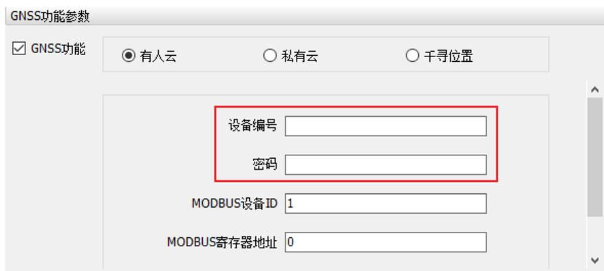
4. 配置从机信息：左侧的从机列表中设置对应的从机号（该值与上位机中的“MODBUS设备ID”对应）；右侧的变量列表中添加两个变量，分别是“30字节 定位型”、“32位时间戳”，二者的寄存器地址是相同的，且寄存器类型必须选择保持寄存器（类型4）：**需要注意的是，云端地址范围有限制，设置的最小值为1，比实际寄存器地址多1个单位，因此存在如下对应关系：云端设置的地址为a，则上位机中的地址就是a-1，这样云端才能正常解析。**至此，有人云相关的准备工作已经完成了。
