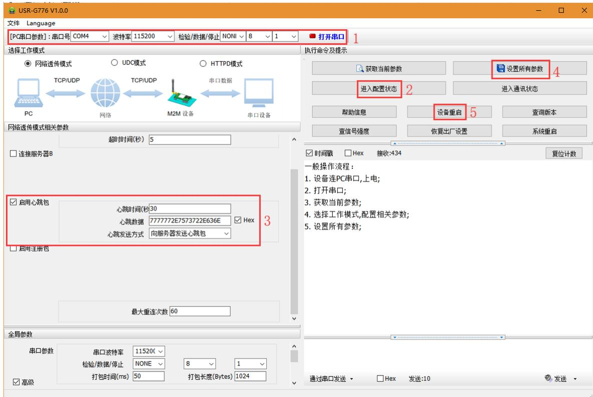
1. 打开专用设置软件“USR-G776.0.X”。根据实际情况设置串口参数并点击“打开串口”。
