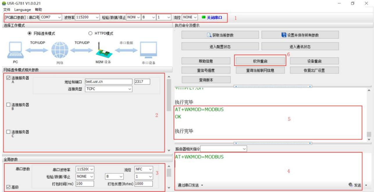
图 111 Modbus 模式设置软件示意图
