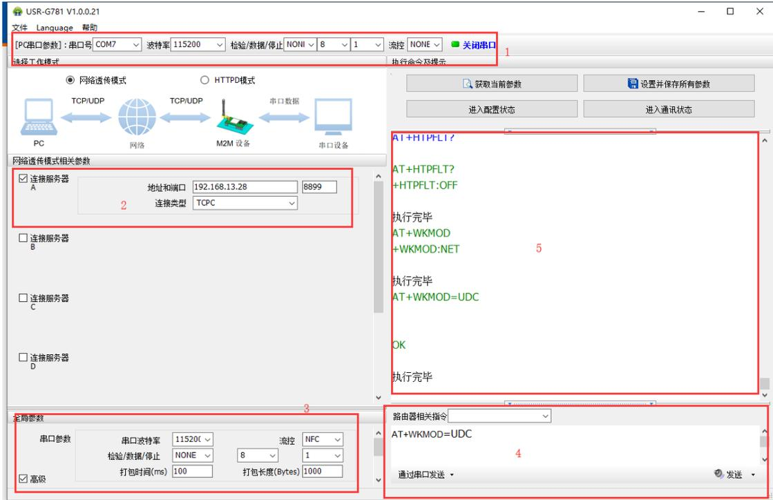
图 113 UDC 模式设置软件示意图
