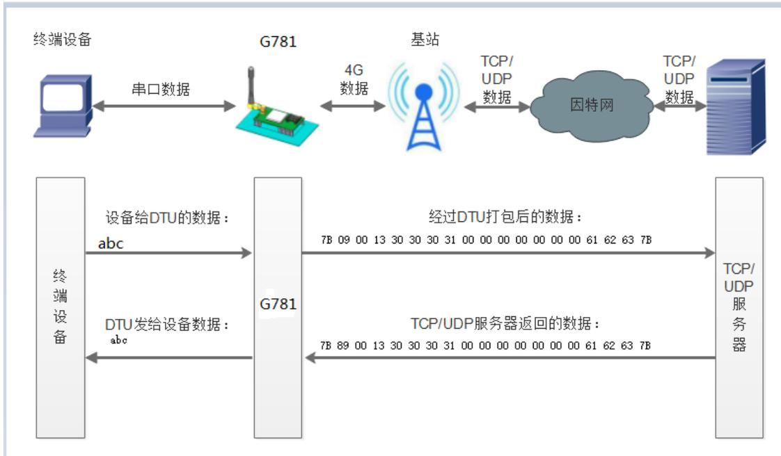
图 112 UDC 协议示意图
