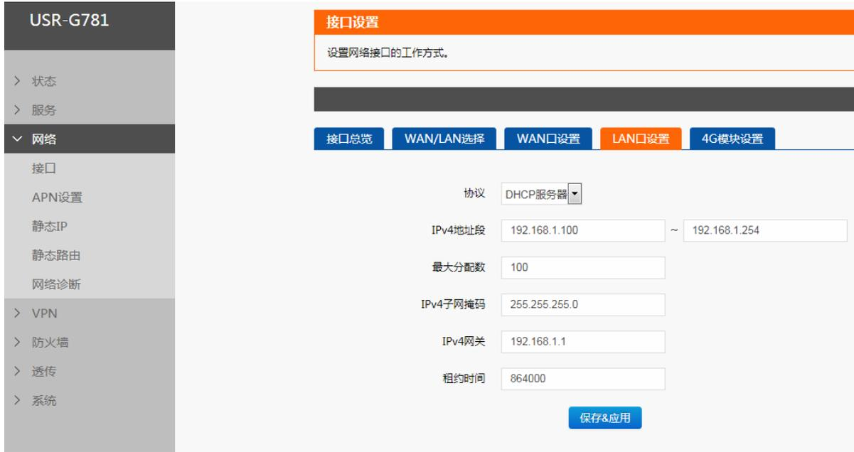
图 27 LAN 口设置 DHCP 服务器
