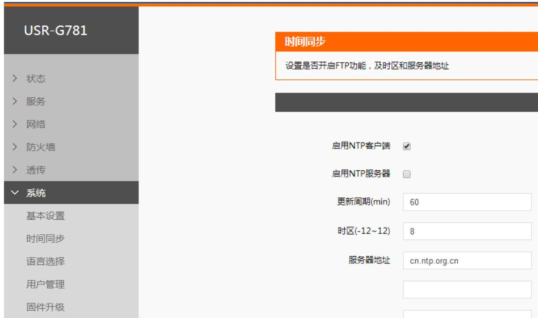
图 10 时间同步（NTP）设置
