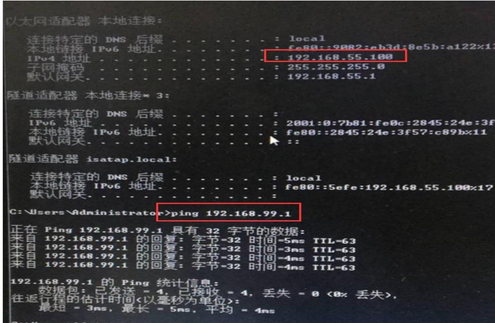
图 44 PPTP 客户端子网 PING 通服务器端 IP
