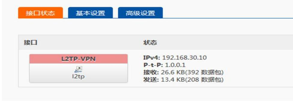
图 56 L2TP 成功连接图
