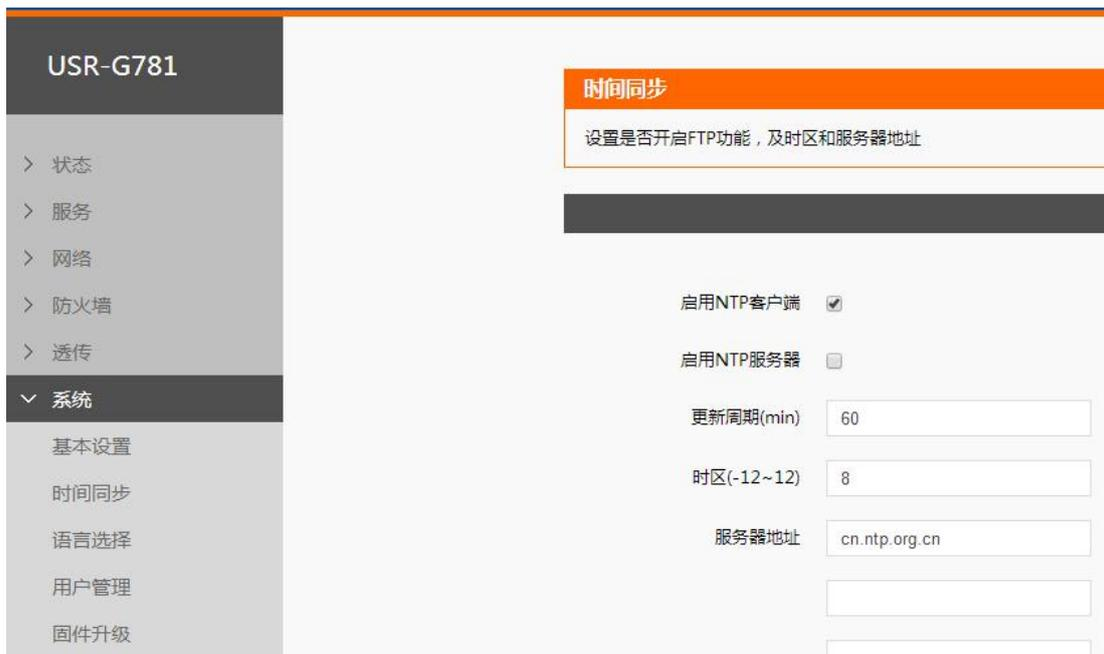
图 10 时间同步 (NTP) 设置
