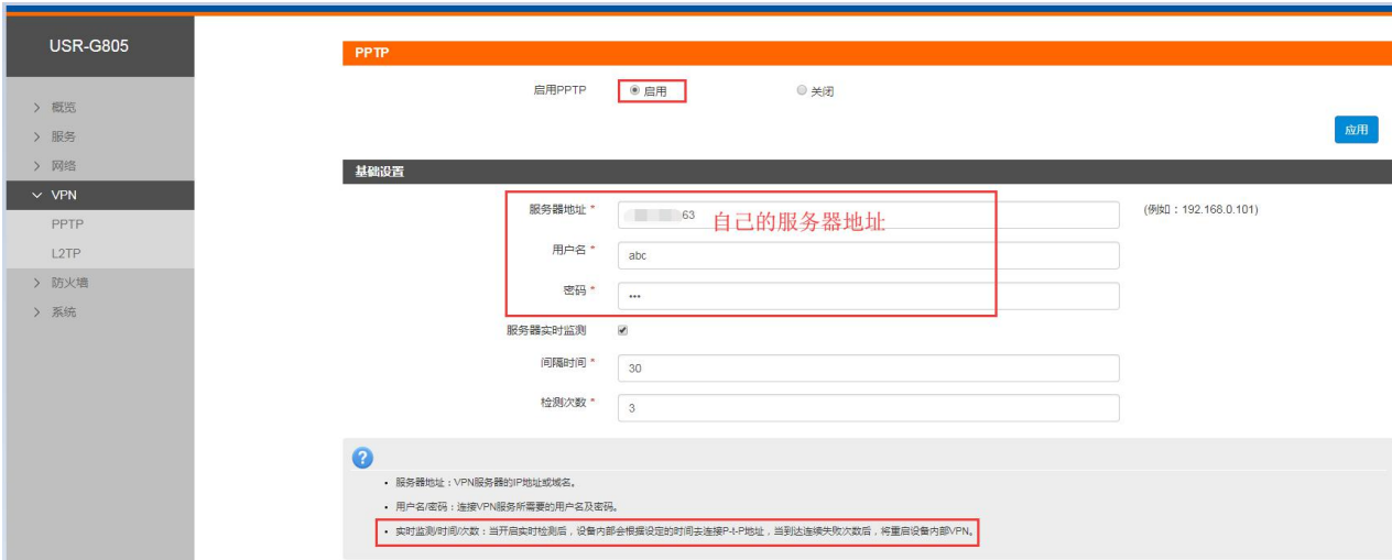
图 47 PPTP 搭建示例：基础设置
