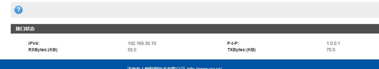
图 59 L2TP 搭建示例：接口状态
