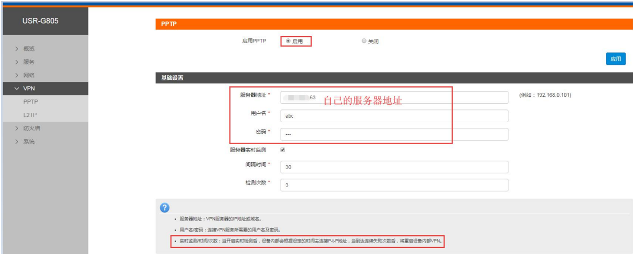
图 47 PPTP 搭建示例：基础设置
