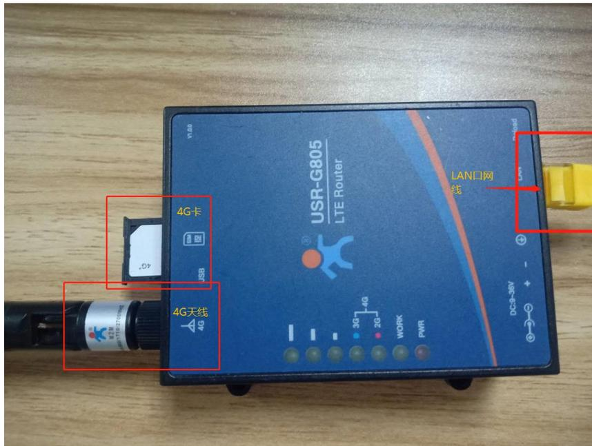
供电：USR-805 工作电压为 DC9~36V，建议配套使用出厂提供的 DC 12V/1A 电源适配器
