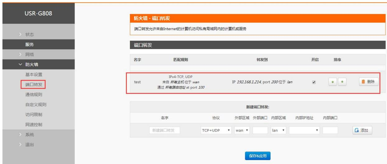
图 64 端口转发设置页面
