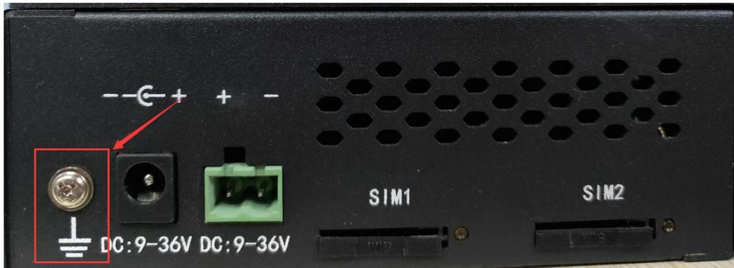
图 3 接地螺丝所在位置
