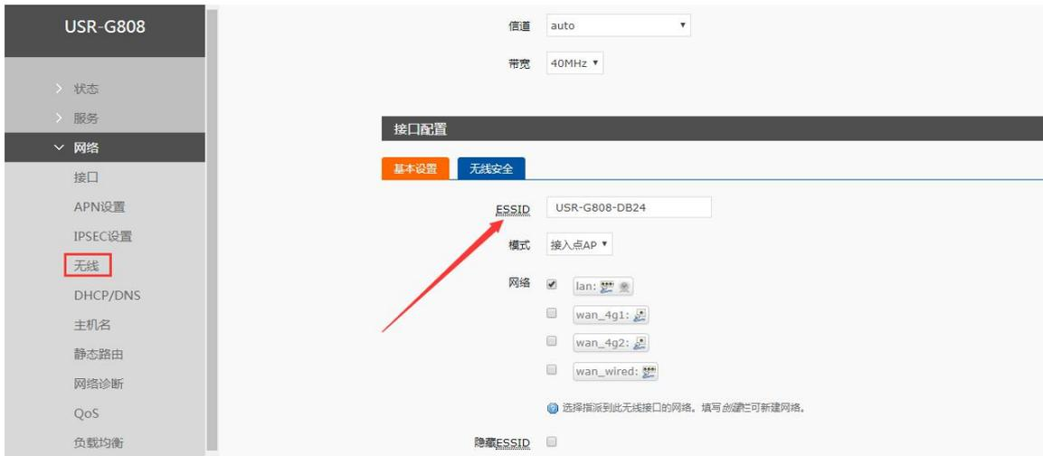
图 38 SSID 设置页面
