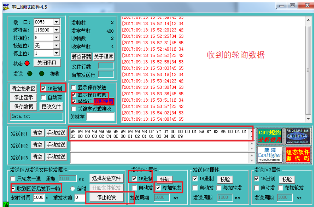
图 20 串口助手-被动轮询模式
