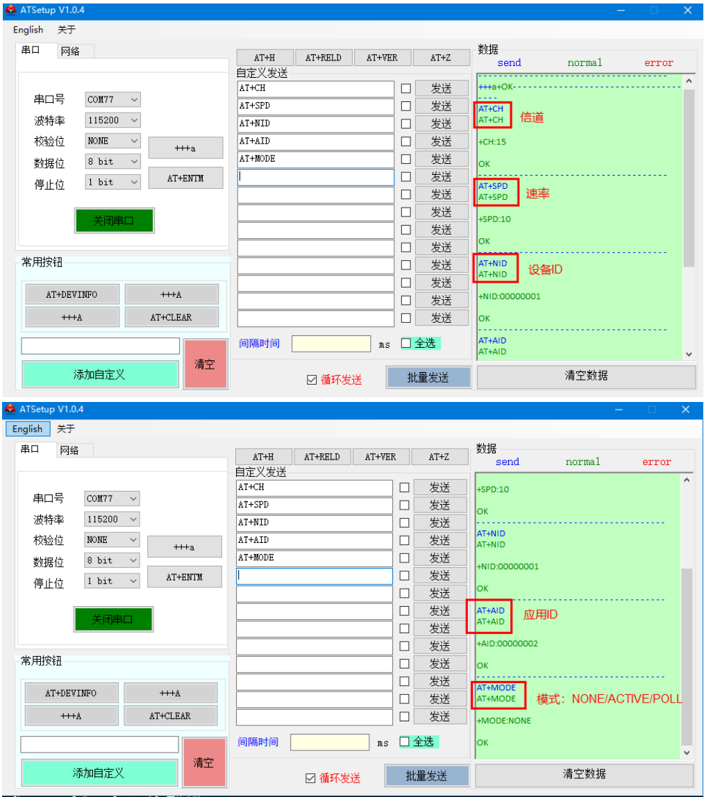
图 19 被动轮询设备设置
